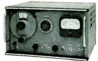
Sierra 101C Carrier Frequency Voltmeter
