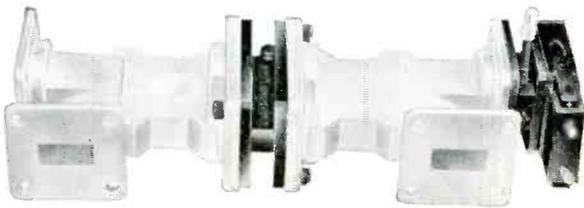
**BALANCED DUPLEXER: DUAL PRE-TR, DIODE PROTECTOR, SHUTTER**
