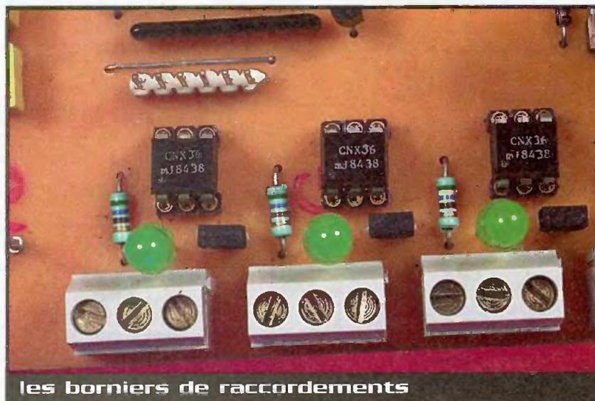
les borniers de raccordement
