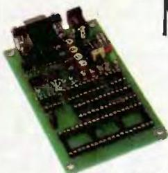
Le PIC-01 permet la programmation des microcontrôleurs PIC de chez Microchip (familles PIC12Cxxx, PIC12CExxx, PIC16Cxxx et PIC16Fxxx), ainsi que les EEproms Séries, (famille 24Cxx). Il supporte les composants en boîtiers DIP 8, 18, 28 et 40 broches permettant la programmation de plus de 60 références différentes. Connectable sur le port série de tout compatible PC, il fonctionne avec un logiciel sous Windows 95/98/NT/2000/ME.
