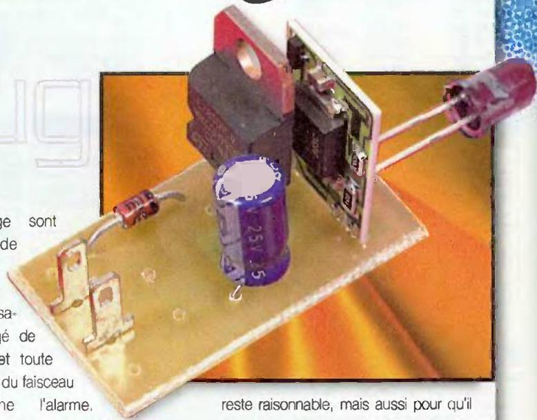
reste raisonnable, mais aussi pour qu'il ne soit pas possible «d'aveugler» le récepteur avec un faisceau infrarouge puissant produit, par exemple, par une torche halogène, on utilise généralement un faisceau impulsif ce qui complique un peu le montage nécessaire lorsque l'on fait appel à des composants discrets. Fort heureusement, la société italienne Telecontrolli, distribuée en France par Lextronic, propose depuis peu deux petits modules hybrides simplifiant à l'extrême une telle réalisation.
