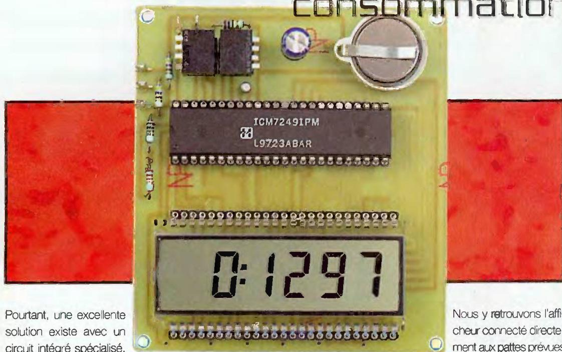
Les compteurs mécaniques ou électromécaniques, utilisés pour comptabiliser des événements ou le temps de fonctionnement de divers appareils, sont encore très peu concurrencés par leurs homologues électroniques. Cette suprématie d'une vieille technologie est due au fait que les compteurs électroniques classiques qui pourraient les remplacer nécessitent généralement une alimentation permanente et souffrent, de ce fait, d'une autonomie trop faible.
