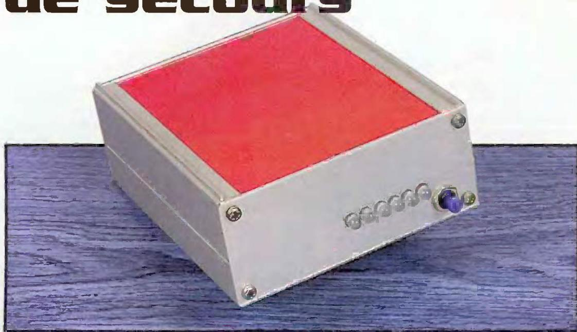
Ce montage a sa place dans un couloir, une cage d'escalier ou tout autre point d'une habitation où il est intéressant de disposer d'un éclairage automatique, de nuit, en cas de disparition du secteur. Grâce à la mise en œuvre de LED blanches à très haute luminosité, la consommation reste très modeste avec un éclairage tout à fait convenable. L'autonomie du dispositif atteint une quinzaine d'heures. Les batteries se rechargent automatiquement dès que le secteur 220V refait son apparition.
