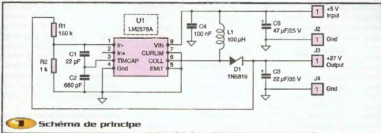
**1** Schéma de principe
