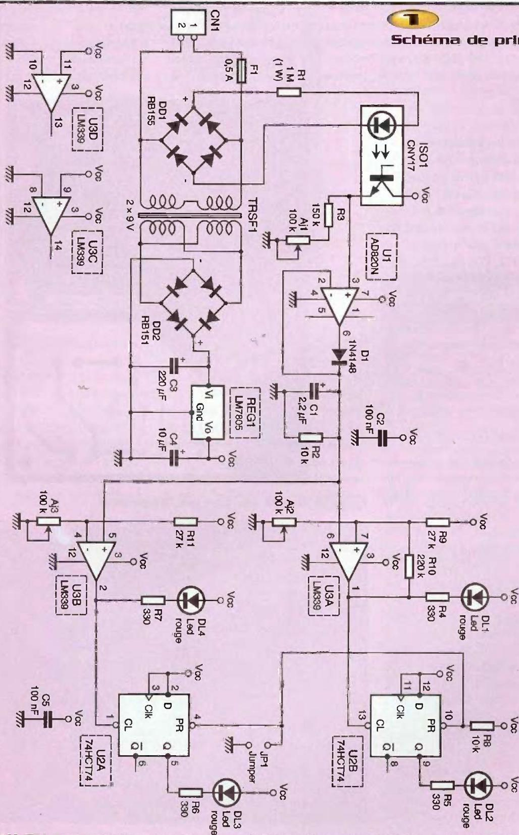
tant que les sorties des comparateurs  $U_{3A}$  et  $U_{3B}$  sont à l'état haut (c'est à dire tant que la tension à surveiller reste dans les limites imposées par  $AJ_2$  et  $AJ_3$ ), les diodes LED resteront éteintes.
