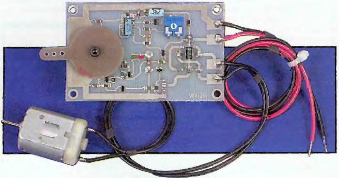
La description qui suit présente une commande de moteur pour modèle réduit de bateau. Elle est entièrement gérée par un servomoteur standard de radiocommande. Nous avons recherché la simplicité et la fiabilité. Malgré son faible coût, ce montage permet le fonctionnement marche avant/arrière du moteur de propulsion, ceci avec deux vitesses de rotation.
