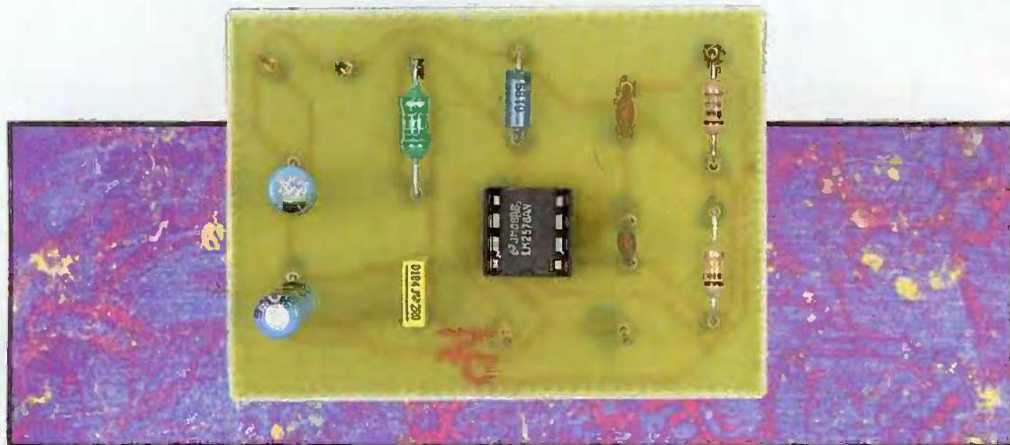
Les boucles à verrouillage de phase (PLL : Phase Lock Loop) sont utiles dans une variété d'applications, plus particulièrement dans les dispositifs d'accord pour le câble et la télévision. Dans ces systèmes, la PLL synchronise un signal de sortie, généralement un oscillateur contrôlé en tension.
