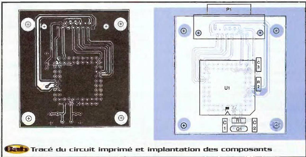
**Bat** Tracé du circuit imprimé et implantation des composants
