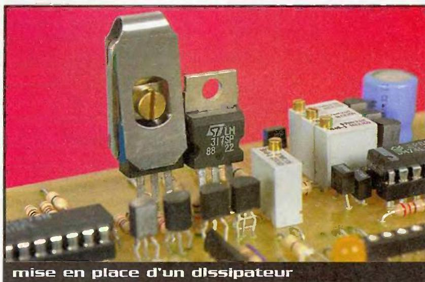
mise en place d'un dissipateur
