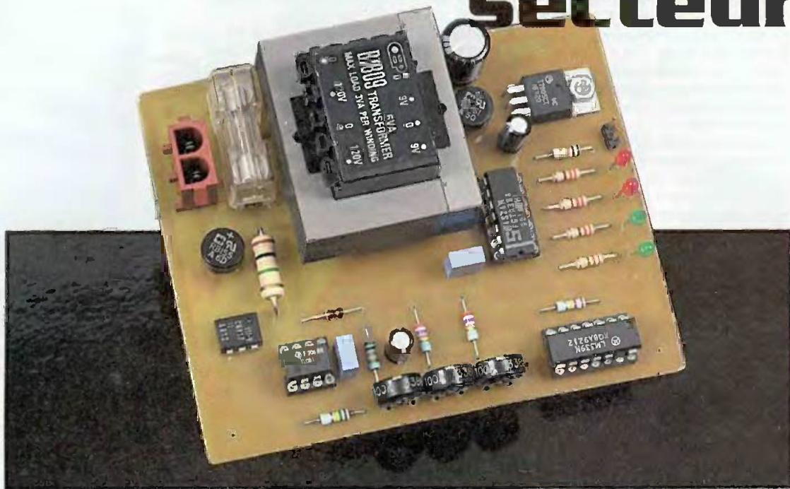
La tension 220V fournie aux abonnés par le réseau EDF n'est pas toujours aussi stable qu'on le pense. Si les fluctuations sont importantes, elles peuvent se révéler désastreuses pour certains équipements fragiles (cas des ampoules longues durée). Pour s'affranchir de ces fluctuations, il faut faire appel à un onduleur, mais ce dernier ne pourra pas subvenir aux besoins électriques de tous les équipements de la maison.
