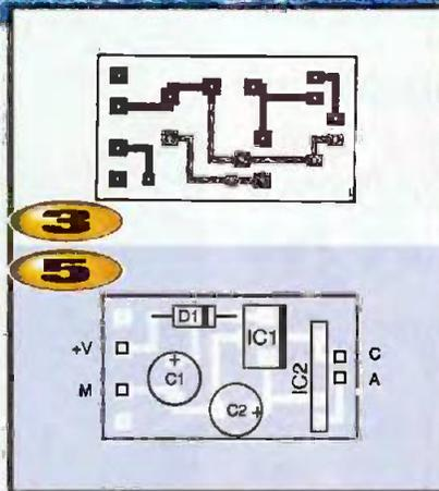
mise en forme. Il commande alors deux organes de sortie : la LED qui s'allume lorsque le faisceau est interrompu, c'est à dire en situation d'alarme, et le relais RL<sub>1</sub> qui est collé lorsque le faisceau est bien reçu et qui décolle en cas d'alarme. Le module comporte son propre régulateur intégré et même une diode de protection contre les inversions de polarité. On peut donc lui appliquer directement en +V une tension comprise entre 9 et 18V non stabilisée.
