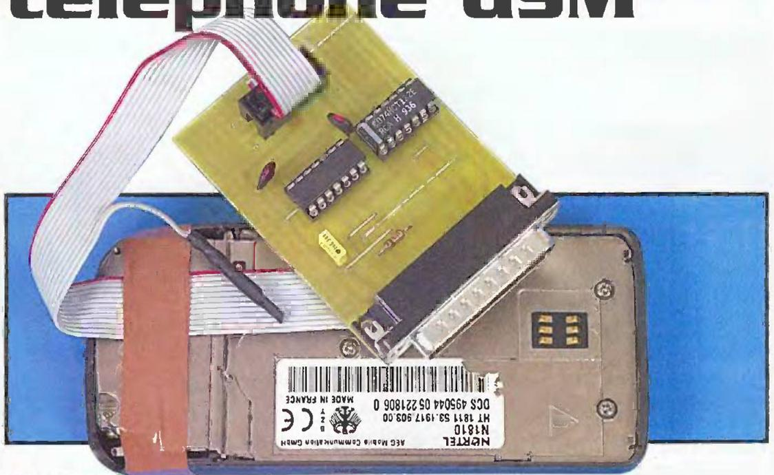
Avec la crise, du fait de l'abondance des téléphones GSM et pour un prix de 10 €, on peut envisager quelques manipulations intéressantes, digne d'une chasse au trésor. Ces manipulations ne concernent que les téléphones utilisant le microcontrôleur MOTOROLA de la famille MC6833X. Ce sont des téléphones de premières générations.
