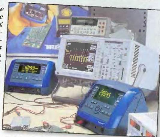
défauts, et le mode **RELATIF** exprimé en absolu, pourcentage ou dB donne accès à une exploitation directe comme, par exemple, le contrôle de la bande passante. De surcroît, grâce à son mode **AUTOPEAK**, le multimètre contrôle en permanence le facteur de crête de la tension ou du courant du signal mesuré et peut, grâce à cette analyse élémentaire, travailler sur une gamme adaptée, éliminant ainsi toute erreur non maîtrisée.
