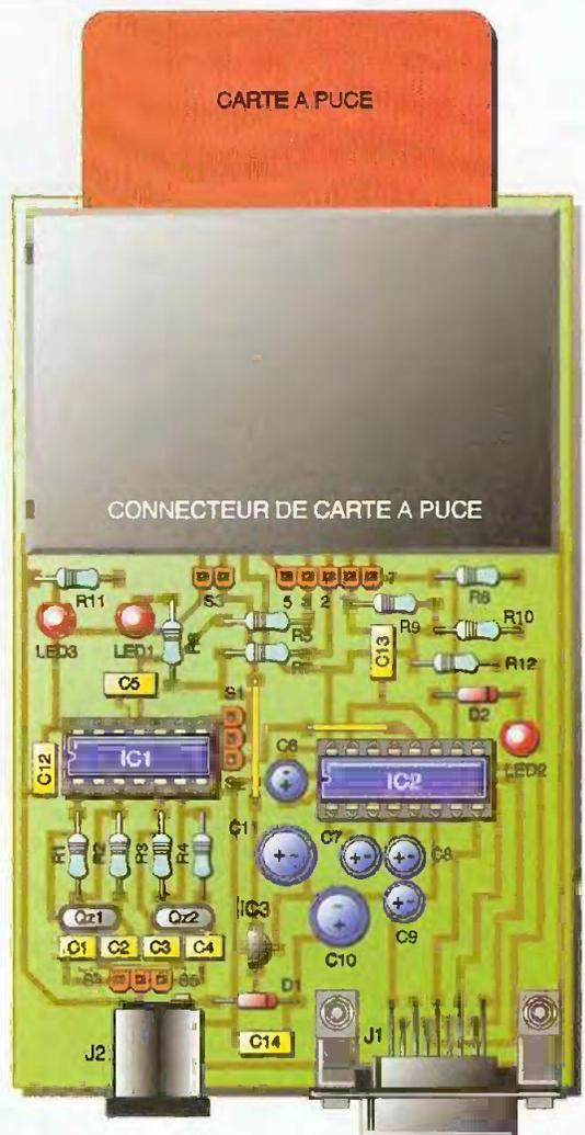
de circuits intégrés, straps, résistances, condensateurs et semi-conducteurs en dernier.
