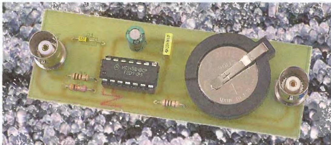
De nombreux générateurs BF n'ont pas de sortie adaptée à des circuits logiques. Le module très simple que nous vous proposons permet d'obtenir des signaux logiques à partir d'un signal quelconque (sinus, triangle, carré ou autre). Il permet aussi de régler la largeur de l'impulsion en jouant seulement sur l'amplitude de la tension fournie par le générateur.
