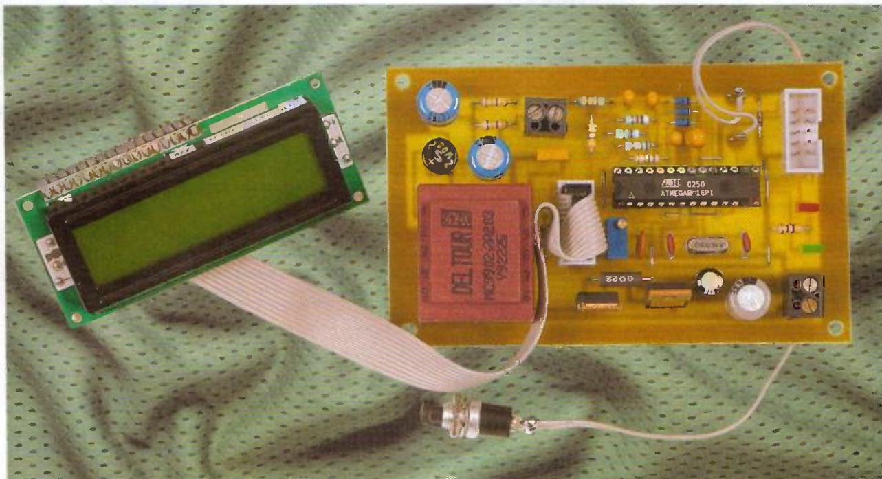
*Le néologisme du titre ne laisse pas de place au doute. Il s'agit bien d'un appareil permettant de connaître la tension nominale, pour un courant donné, d'une diode zener, diac, Transil, LED, ou encore la tension de seuil d'une diode classique. La plage des tensions mesurées s'étend jusqu'à une centaine de volts, ce qui permet de couvrir les cas les plus courants. Cette application met en exercice le convertisseur analogique/numérique du microcontrôleur, ainsi que son générateur PWM.*
