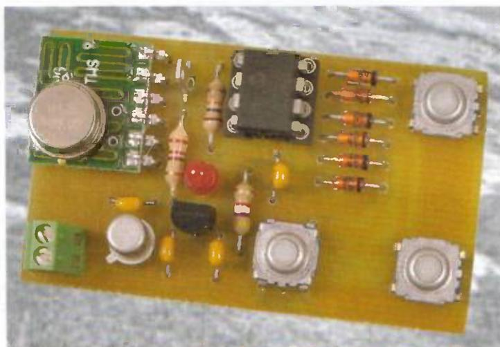
**Ce montage est le complément du récepteur universel décrit dans le n° 283 d'Électronique Pratique. Il remplacera avantageusement les télécommandes de type "porte clés" qui utilisent les circuits spécialisés MM 53200 ou UM 3750, mais on n'aura pas besoin de positionner les 12 mini interrupteurs qui déterminent le code, car il sera capable de le choisir lui-même.**
