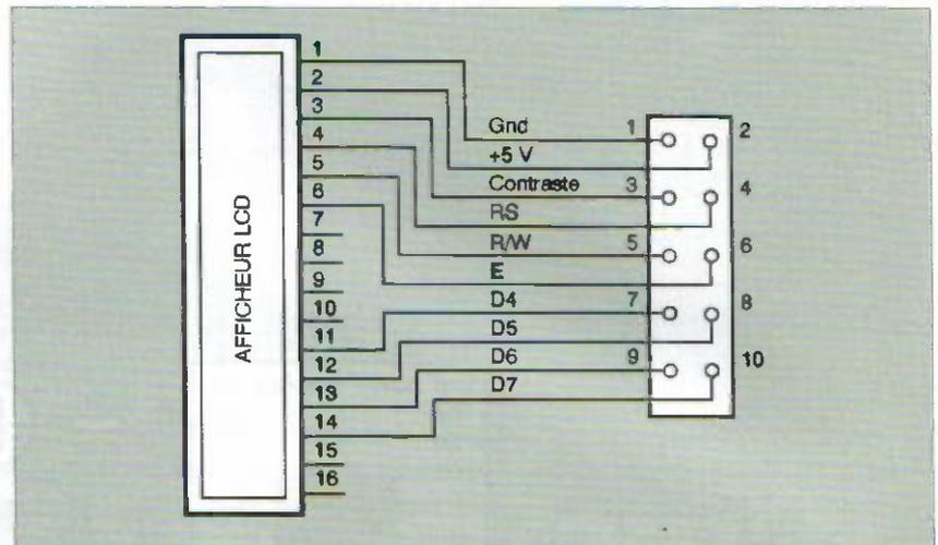
**3** Détails des connexions vers l'afficheur
