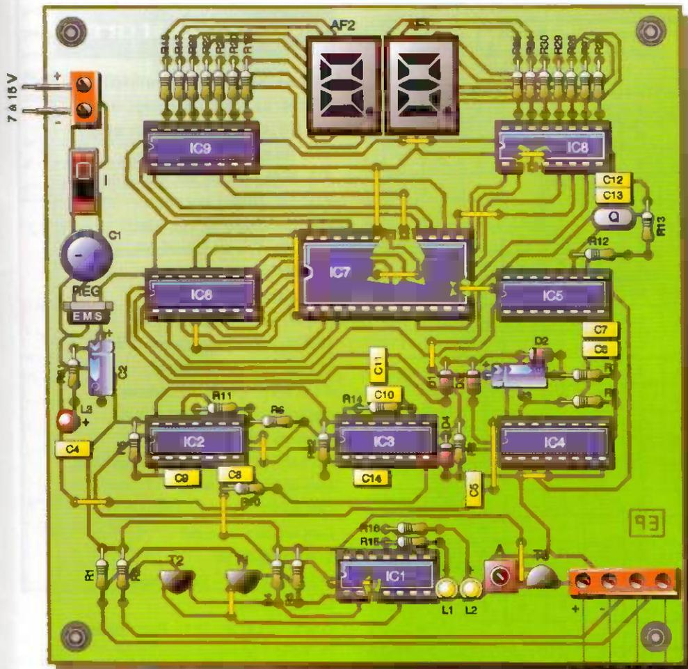
tilles sont à percer à l'aide d'un foret de 0,8 mm de diamètre. Certains trous sont à agrandir par la suite afin de les adapter aux diamètres des connexions des composants les plus volumineux.
