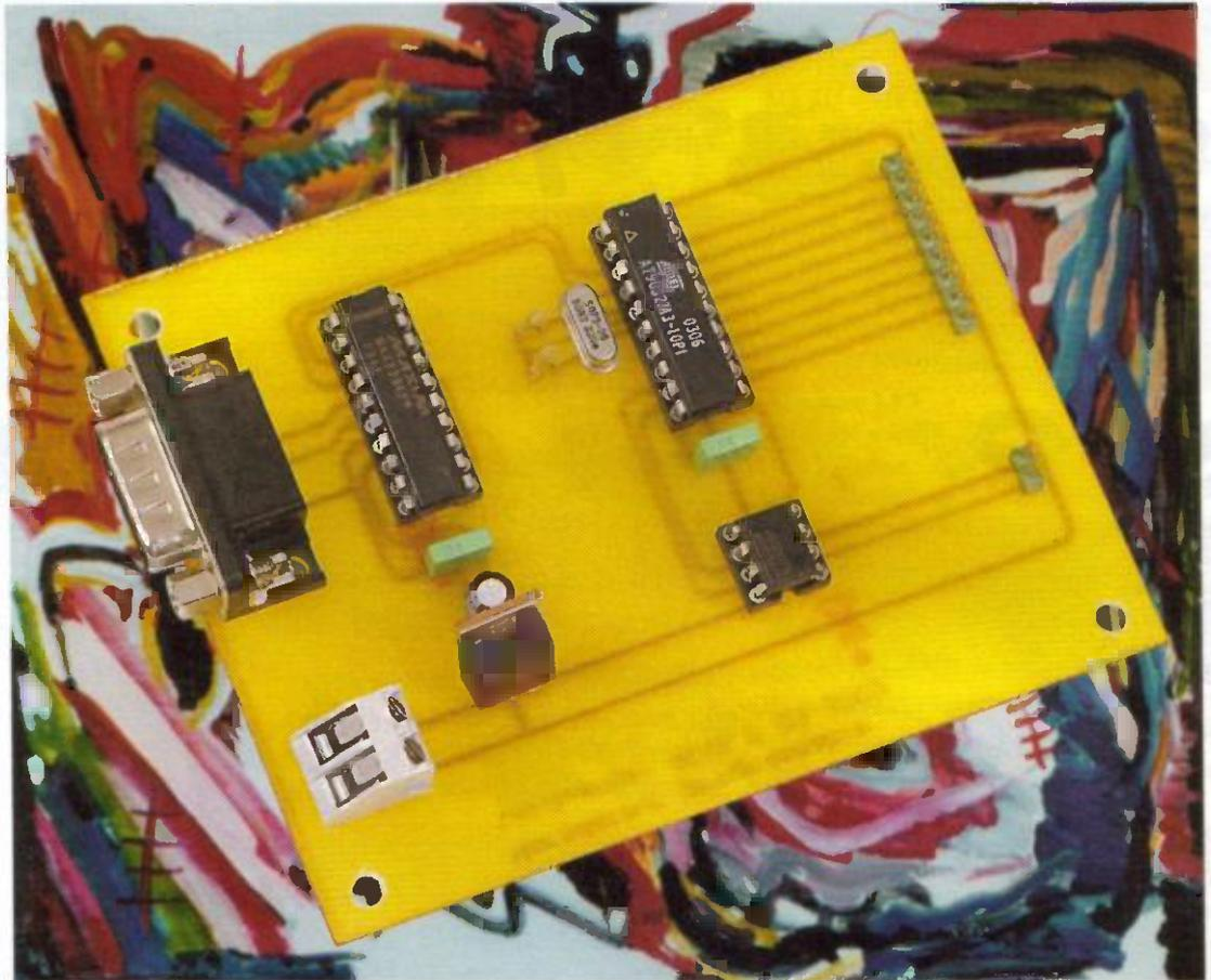
*Ce petit outil est destiné à surveiller l'état d'un système, d'une machine, d'un capteur et informer l'utilisateur sur le moment précis où est apparu un changement d'état significatif. Il dispose de huit entrées logiques 0..5 V et d'une entrée analogique 0..5 V.*
