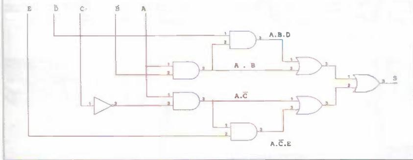
**7** Exemple de schéma optimisé après analyse de l'équation.
