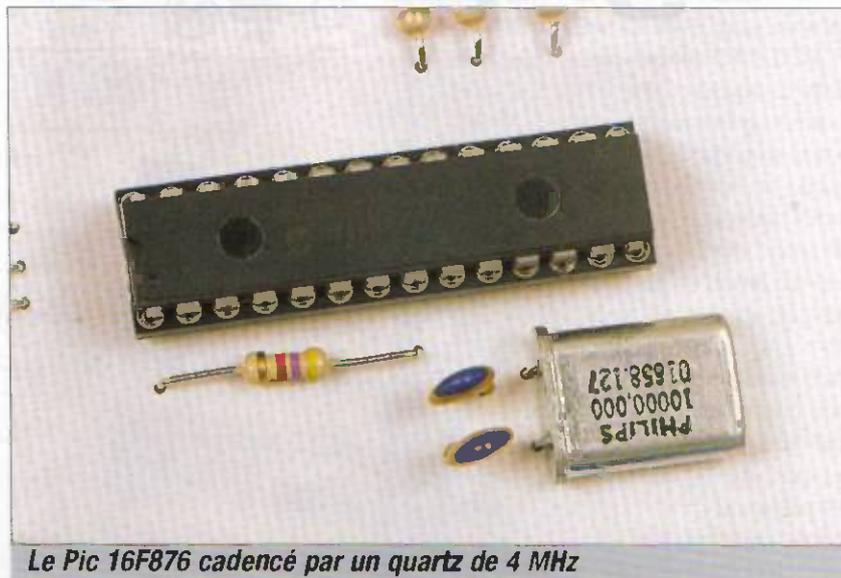
Le Pic 16F876 cadencé par un quartz de 4 MHz
