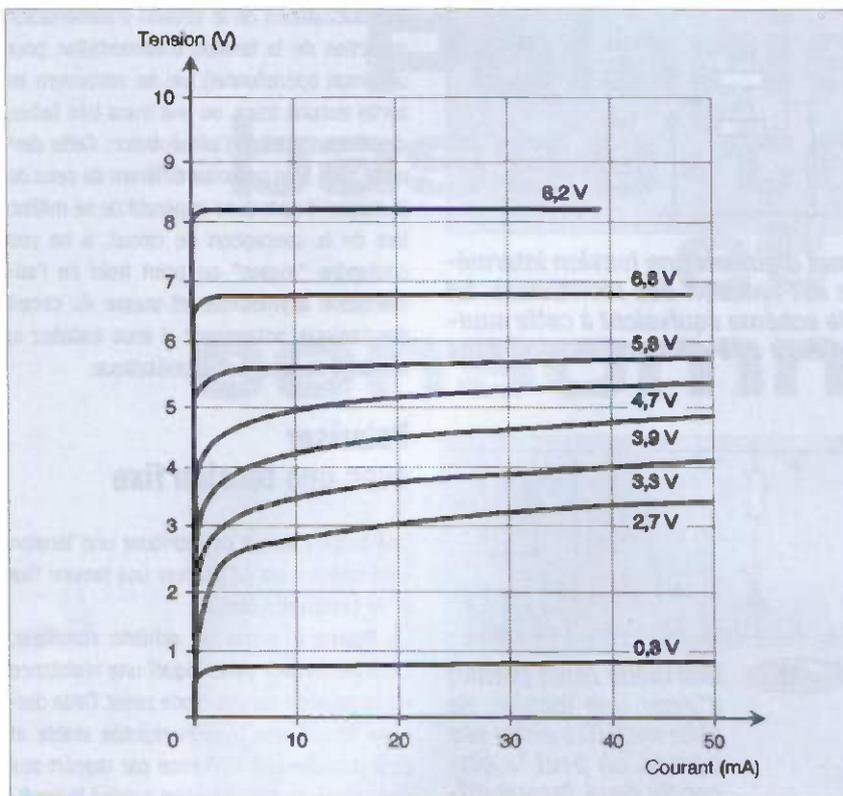
**5** Courbe tension/courant de diverses diodes zeners. On constate que pour les faibles tensions, la courbe est très arrondie, elle devient plus anguleuse lorsque la tension augmente. La résistance dynamique diminue aussi pour les fortes tensions.
