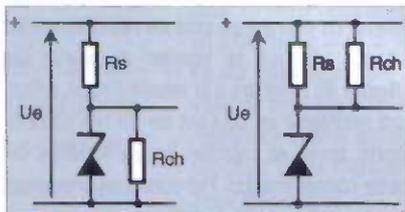
**6** En chargeant la référence, on modifie le courant qui la traverse. A gauche, si la résistance série conserve la même valeur, la diode est traversée par un courant plus faible. A droite, le courant augmente.
