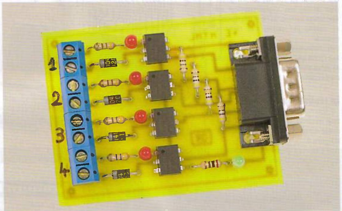
*Voici un montage qui est loin d'être une nouveauté sur le plan électronique puisqu'il permet la lecture de quatre entrées logiques via le port série d'un PC. De nombreux articles publiés dans Interfaces PC traitent du même sujet, mais la méthode utilisée ici pour lire l'état des entrées est très simple.*
