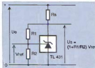
**7** La diode zener ajustable utilise un pont de résistances externe pour fixer sa valeur nominale. Le TL 431 travaille à partir d'un courant inférieur à celui d'une diode zener et assure une meilleure stabilité de tension.
