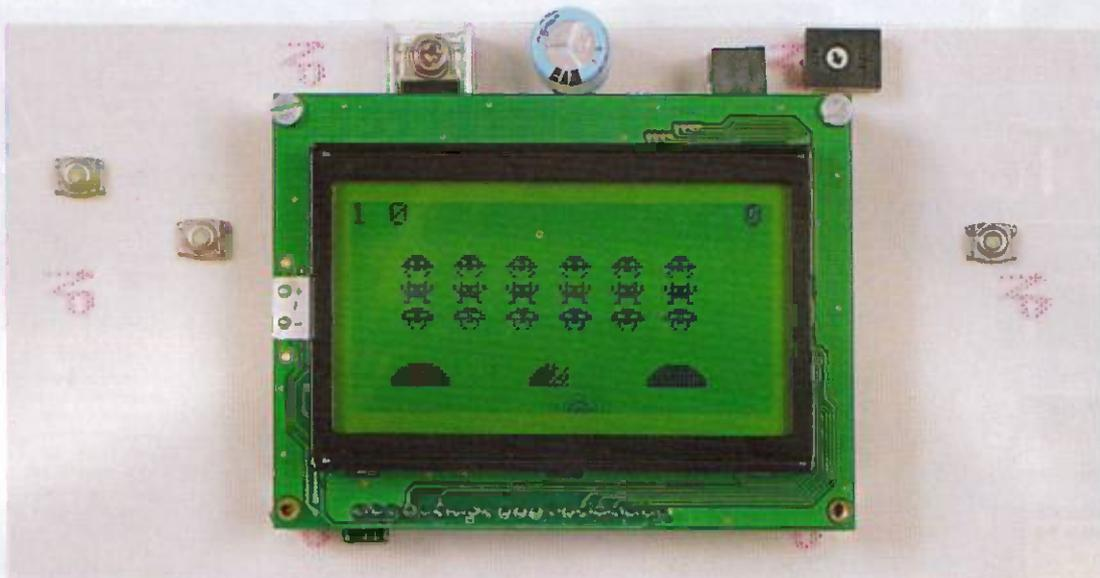
**Ce montage reproduit le fameux jeu électronique Space Invader. Simple à réaliser à l'aide d'une poignée de composants et amusant à utiliser, ce montage est surtout destiné à faire découvrir ou redécouvrir de façon ludique et édifiante la programmation des microcontrôleurs à l'aide d'un compilateur. En effet, le microprogramme gérant notre montage est entièrement écrit en basic !**
