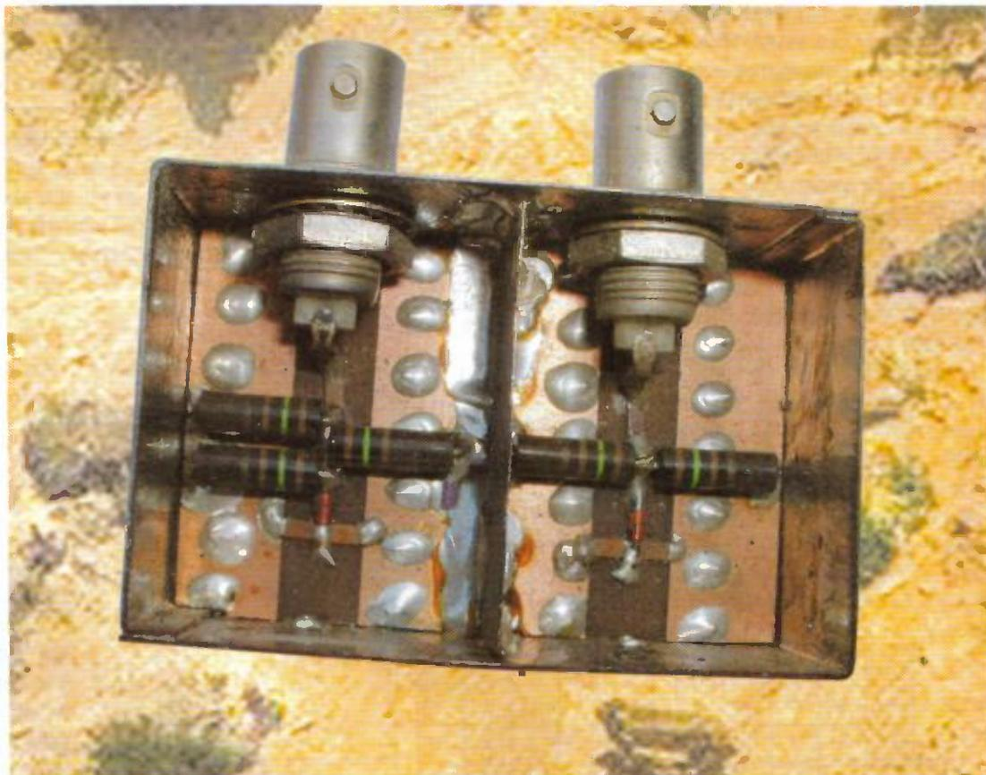
*Nous vous proposons, dans l'article qui suit, le procédé de réalisation ainsi que le moyen de calculer les diverses résistances entrant dans la fabrication des atténuateurs, que ce soit ceux utilisés en HF où l'on travaille sur l'impédance caractéristique des lignes, ou ceux des circuits électroniques, où une impédance d'entrée et de sortie doit être respectée.*
