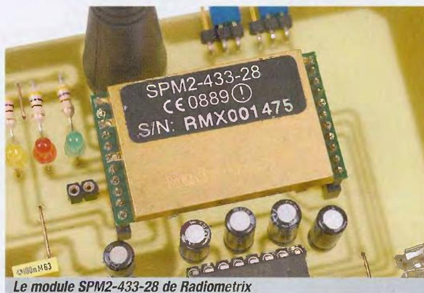
Le module SPM2-433-28 de Radiometrix
