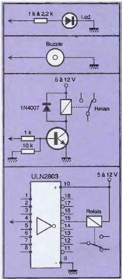
**4 Exemples de circuits pouvant se raccorder aux sorties du CD 4060**
