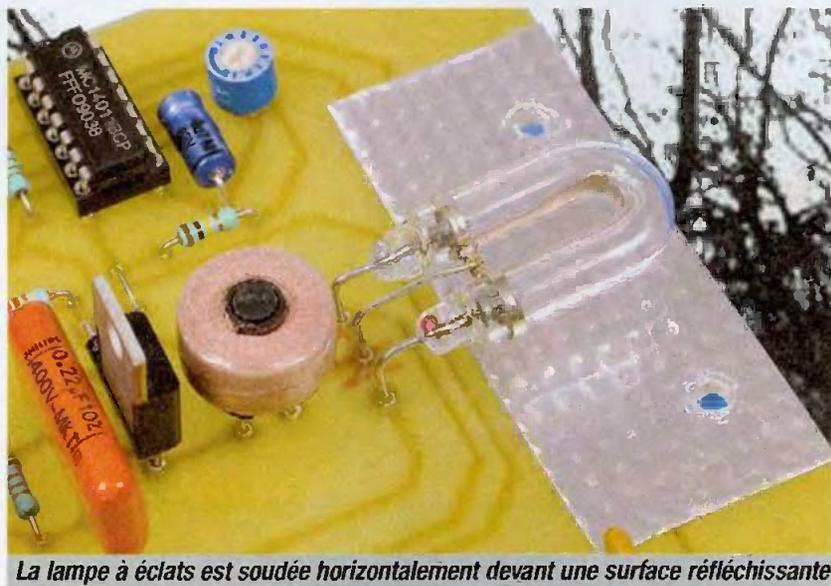
La lampe à éclats est soudée horizontalement devant une surface réfléchissante
