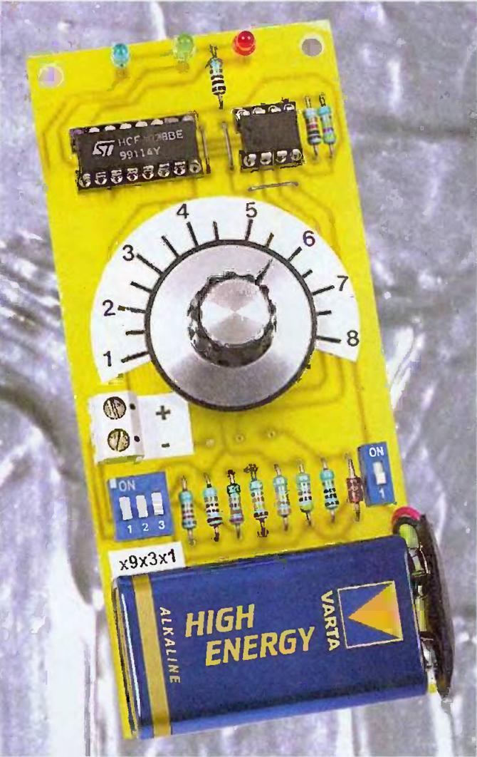
cipe d'utilisation du voltmètre consiste à tourner le bouton-flèche du potentiomètre devant un secteur gradué, dans un sens ou dans l'autre, pour aboutir sur une position particulière pour laquelle une LED de signalisation verte s'allume.
