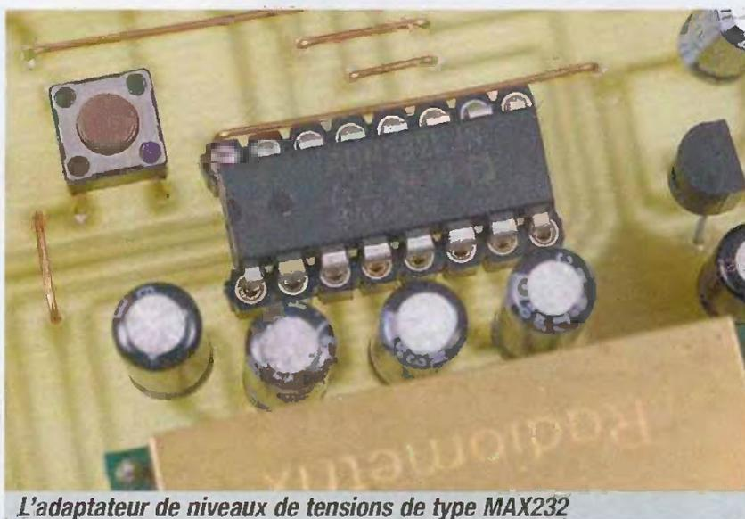
L'adaptateur de niveaux de tensions de type MAX232
