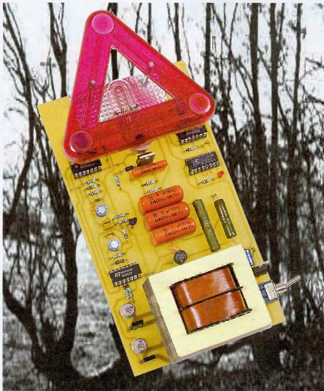
*Sur la route, il est indispensable de respecter une règle simple : voir et être vu. L'observation de ce précepte revêt une importance encore plus grande de le cas d'un arrêt inopiné sur le bas côté de la route suite à une panne ou à une crevaison. Le montage proposé, branché sur la prise allume-cigare du véhicule, émet périodiquement de puissants éclairs signalisant le danger.*
