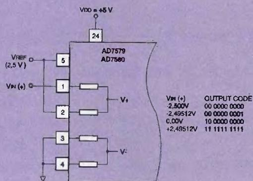
Une particularité doit être signalée : le circuit AD7579 ne disposant que d'un bus de données de huit bits alors qu'il donne un résultat sur dix bits, une fonction supplémentaire lui a été adjointe.
