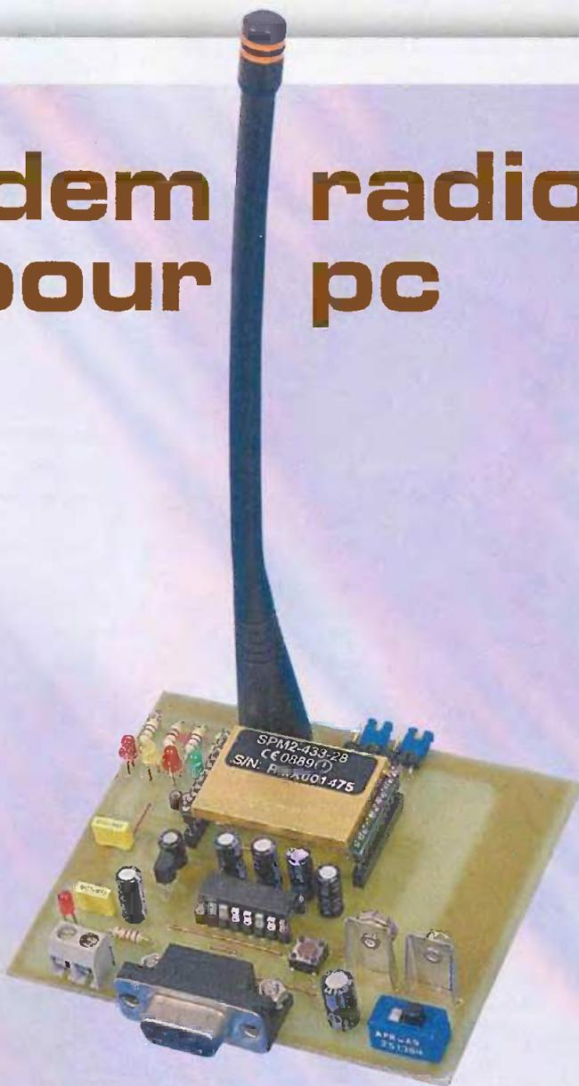
*Le montage que nous décrivons dans cet article permet la communication entre deux ordinateurs de type PC avec une fiabilité exceptionnelle. Les données envoyées sont en effet contrôlées et le risque d'erreurs durant la transmission est quasiment inexistant. D'autre part, la vitesse de communication est également exceptionnelle pour ce type de transmission.*
