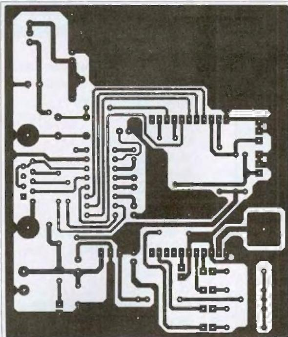
**7** Tracé du circuit imprimé
