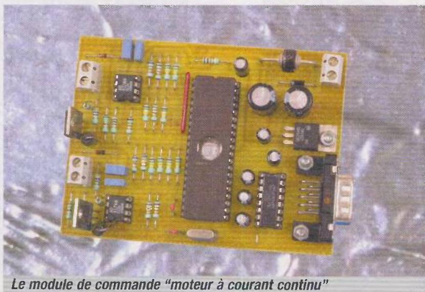
Le module de commande "moteur à courant continu"
