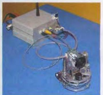
*Cette tourelle gyrostabilisée sera la charge utile du drone électrique de Bertin*
