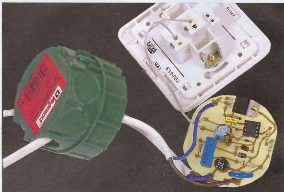
**Cette nouvelle application d'un PIC à huit pattes vous permettra de piloter astucieusement toute sorte de petits éclairages secteur à peu de frais. Le circuit imprimé a été suffisamment réduit pour être logé dans un simple boîtier de connexion électrique pouvant servir de support à un bouton poussoir à encastrer.**
