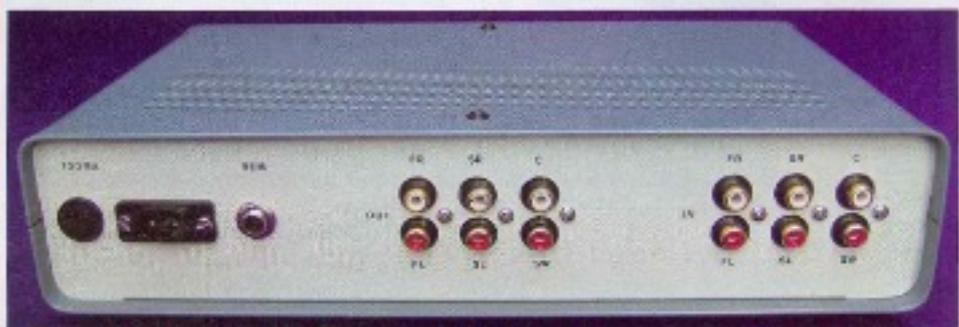
Photo 4 : Face arrière du préamplificateur muni de ses diverses prises de raccordements
