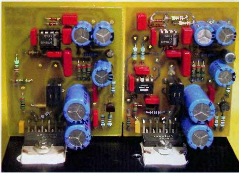
Photo 2 : Assemblage en pont des deux modules (inverseur et non inverseur)
