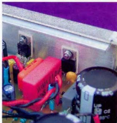
isolés par un mica ou un isolant souple à base de graisse au silicone et un canon isolant pour TO220 et fixés par une vis M2,5 (photo 4).
