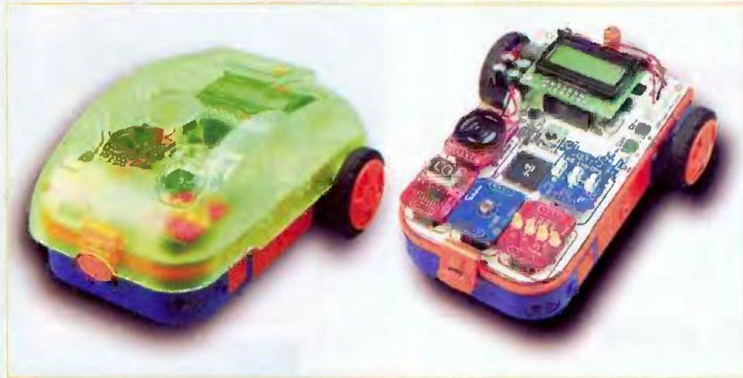
La société Lextronic propose un tout nouveau robot ludique entièrement programmable via des icônes graphiques. Ce dernier se compose d'une base mécanique dont la motricité est assurée par deux moteurs DC associés à une roue folle. La partie électronique (recouverte par un capot de protection translucide) est livrée pré-assemblée (aucune soudure ne sera nécessaire pour la mise en œuvre du robot). Architecturée autour d'un microcontrôleur Atmel ATMEGA64L, cette platine électronique se compose de :
