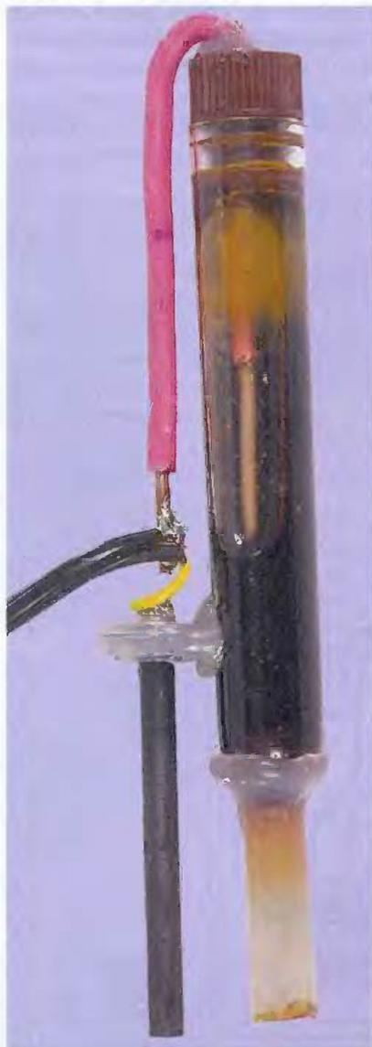
métallique de la tige en graphite. Il reste à remplir la sonde avec la solution contenant les ions Cu<sup>2+</sup> avant de replacer le bouchon. Voyons comment préparer cette solution. Si la sonde en fabrication doit rester vide durant plusieurs jours, il faudra la plonger entièrement dans l'eau salée afin que le pont salin ne se déshydrate pas, auquel cas il deviendrait inutilisable.
