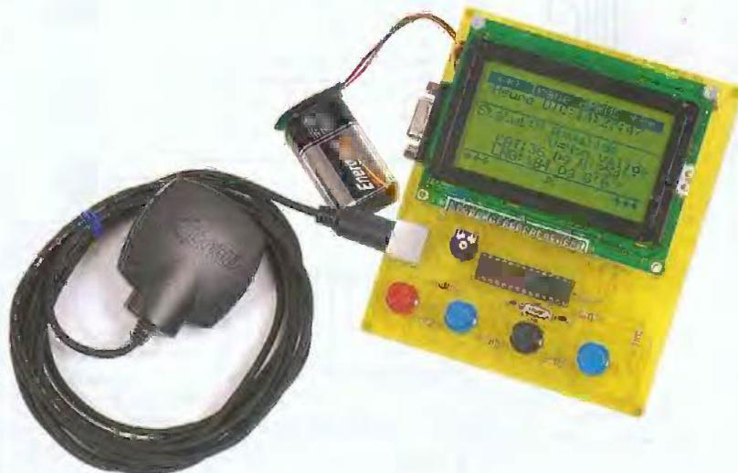
prise série GR-CP1 qui exploite la norme NMEA 0183 deuxième version ainsi que le datum WGS 84. Ce modèle est proposé par le revendeur Electronique Diffusion et son brochage est représenté en figure 1.
