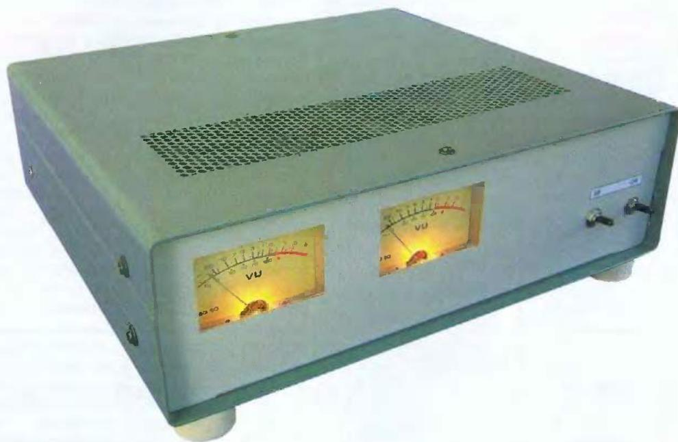
**Cette réalisation particulièrement soignée est présentée dans un habillage compact. L'amplificateur développe une puissance de 2 x 10 Weff avec une distorsion harmonique inférieure à 0,1 %.**
