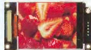
manipuler des « blocs images » sur l'écran, de modifier la fonte des caractères, d'afficher du texte en mode opaque ou transparent, de modifier le rétro-éclairage et le contraste, d'activer-désactiver un défilement à l'écran, etc. L'afficheur dispose également d'un connecteur capable de recevoir une carte mémoire au format micro SD de
