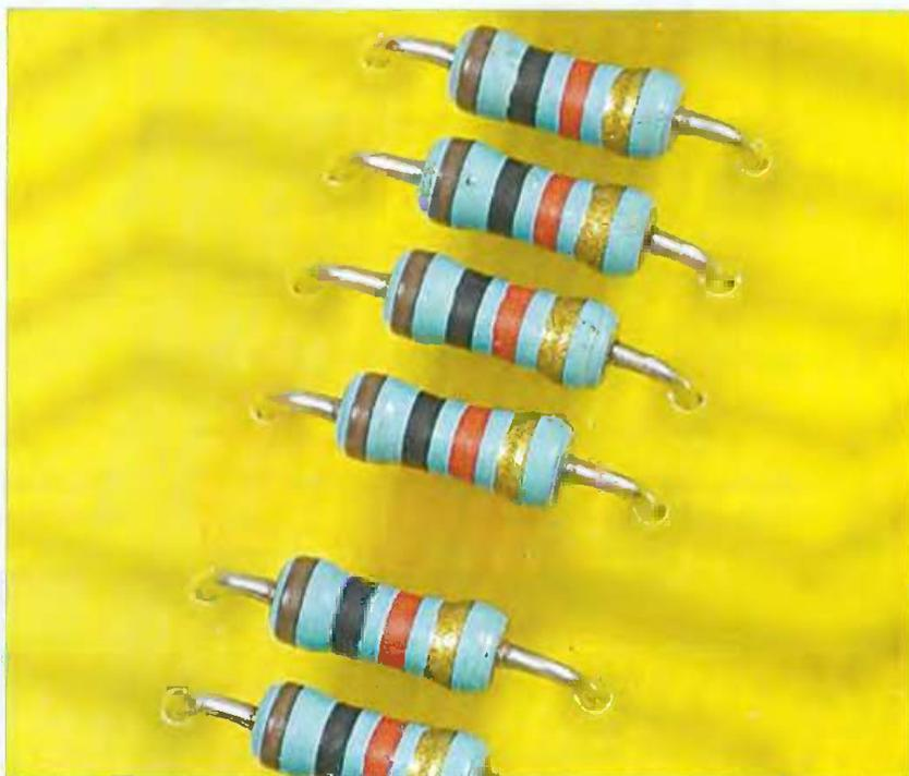
résistances à couche de carbone. Le carbone était disposé sous forme de fine couche et en spirale sur un barreau isolant en céramique.
