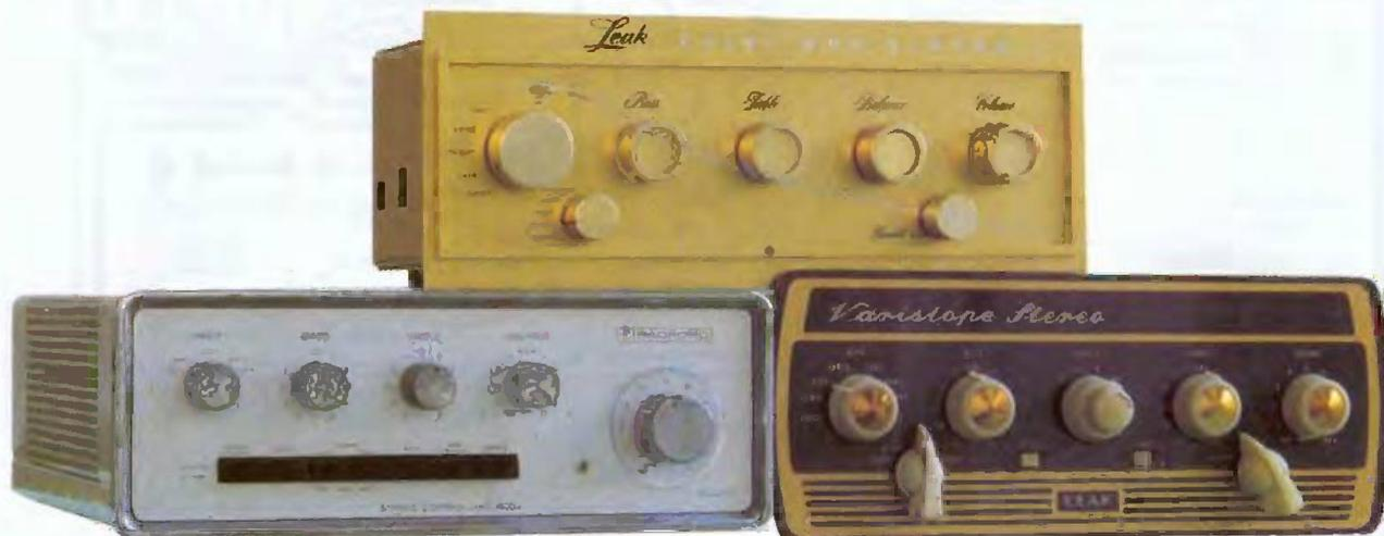
Après avoir étudié les amplificateurs STA25 de Radford et Stéréo 60 de Leak, voici les préamplificateurs accompagnant ces deux électroniques de puissance qui ont pour principale caractéristique d'être alimentés par leurs amplificateurs respectifs.
