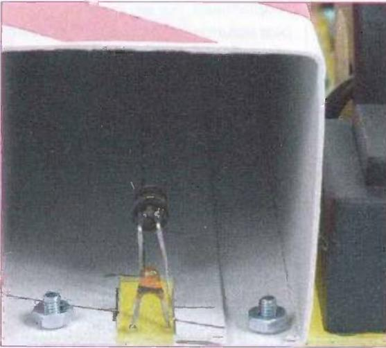
Entrée du canal d'aspiration avec présence des détecteurs : une diode infrarouge pour la fumée et une CTN pour la température
