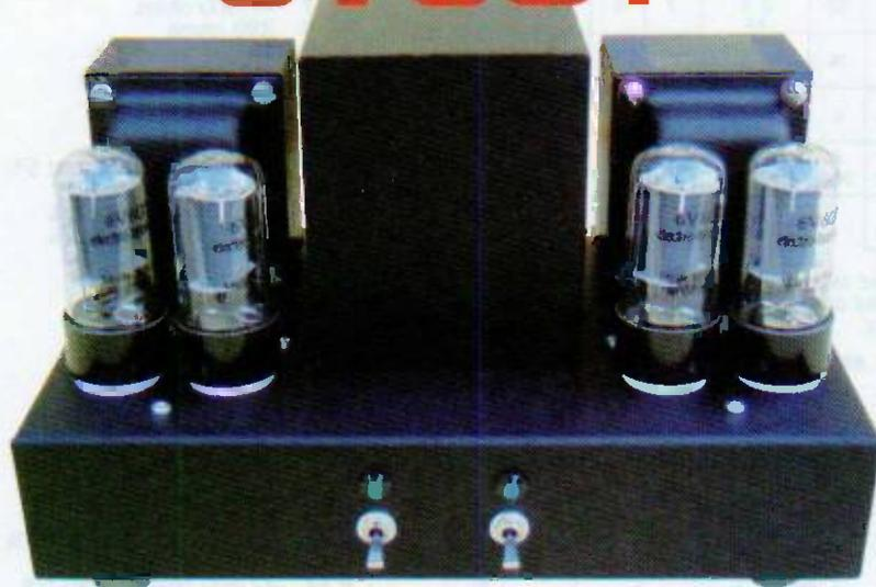
Cet amplificateur met en œuvre un système hybride composé d'un push-pull de 6V6GT piloté par deux transistors à effet de champ. L'appareil développe une puissance de 2 x 12 W, sa bande passante s'étend de 25 Hz à 32 kHz à -1dB. Il constitue le troisième volet de nos amplificateurs compacts déjà présentés dans les n° 327 et 331 d'*Electronique Pratique*.
