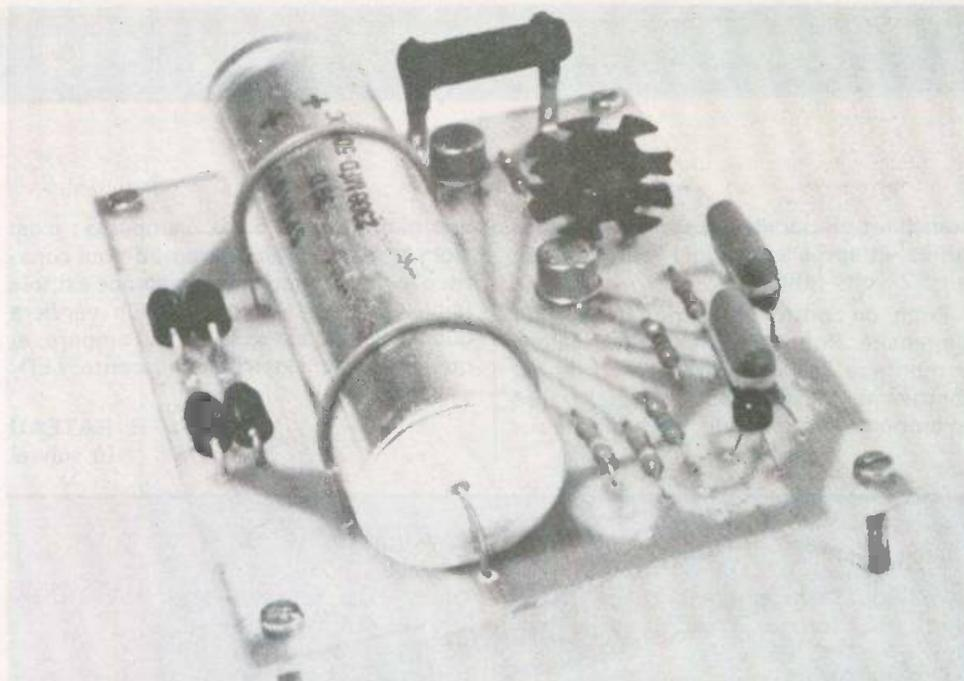
Photo C. - Circuit de l'alimentation 0-30 V.
