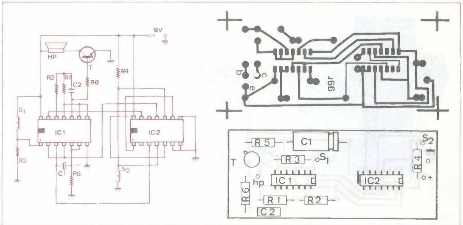
Fig. 1. à 3. - Le montage d'alarme est construit autour de deux circuits intégrés C.MOS, qui autorisent une consommation en état de veille de l'ordre de  $15 \mu\text{A}$ . Tracé du circuit imprimé et implantation des éléments à l'échelle 1.
