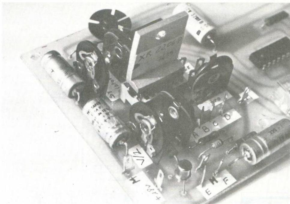
Photo 3. – Les cinq ajustables et le C.I. XR 2206 muni d'un petit radiateur qui sera ensuite relié à un fil de masse.
