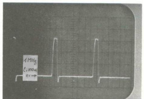
Photo 17. - Limites mini du générateur d'impulsions positives : F = 1 MHz, largeur de pic : 100 ns.
