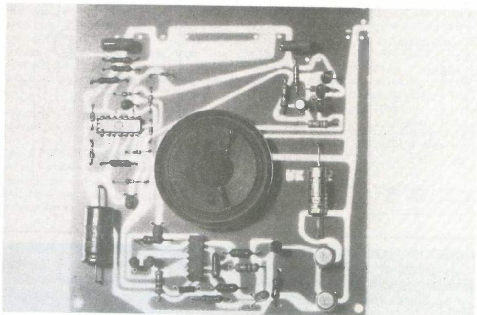
Photo A. - Les composants apparaissent en situation. On peut même reconnaître la section sirène avec ses éléments associés.
