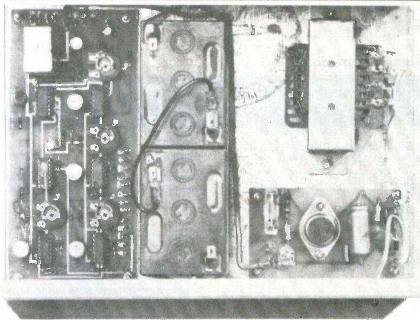
Photo B. - Vue de dessus du montage. On localise parfaitement l'alimentation et son transformateur et les batteries.
