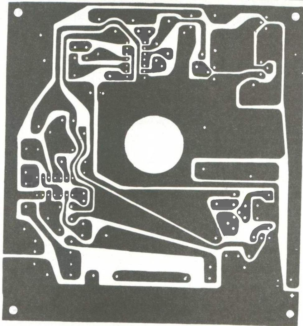
Fig. 6. et 7. - Le tracé du circuit imprimé est donné grandeur nature. Si l'on emploie la méthode stylo marqueur, il ne sera pas nécessaire de noircir les parties cuivrées comme sur le dessin. Implantation pratique des éléments.
