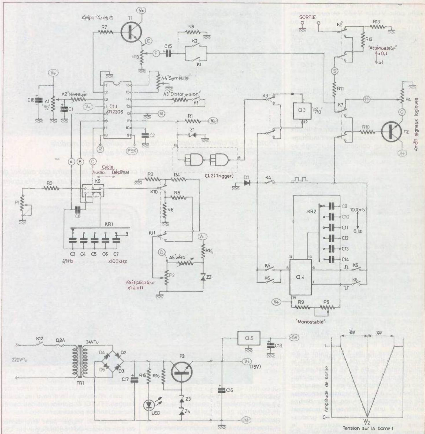
Fig. 1. à 3. - Le circuit électronique fait appel à un circuit intégré spécial et à trois circuits intégrés TTL courants pour parfaire les signaux logiques. La plupart des commutations s'effectuent à touches par un clavier. Schéma alimentation. La modulation de l'amplitude par la borne 1 exige des tensions de commande assez élevées. Nous n'avons pas utilisé cette possibilité.
