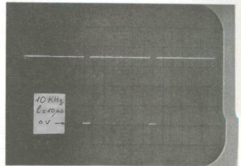
Photo 13. - En générateur d'impulsions la largeur des pics est réglable de 100 ns à 0,1 s. Ici des impulsions « négatives ».
