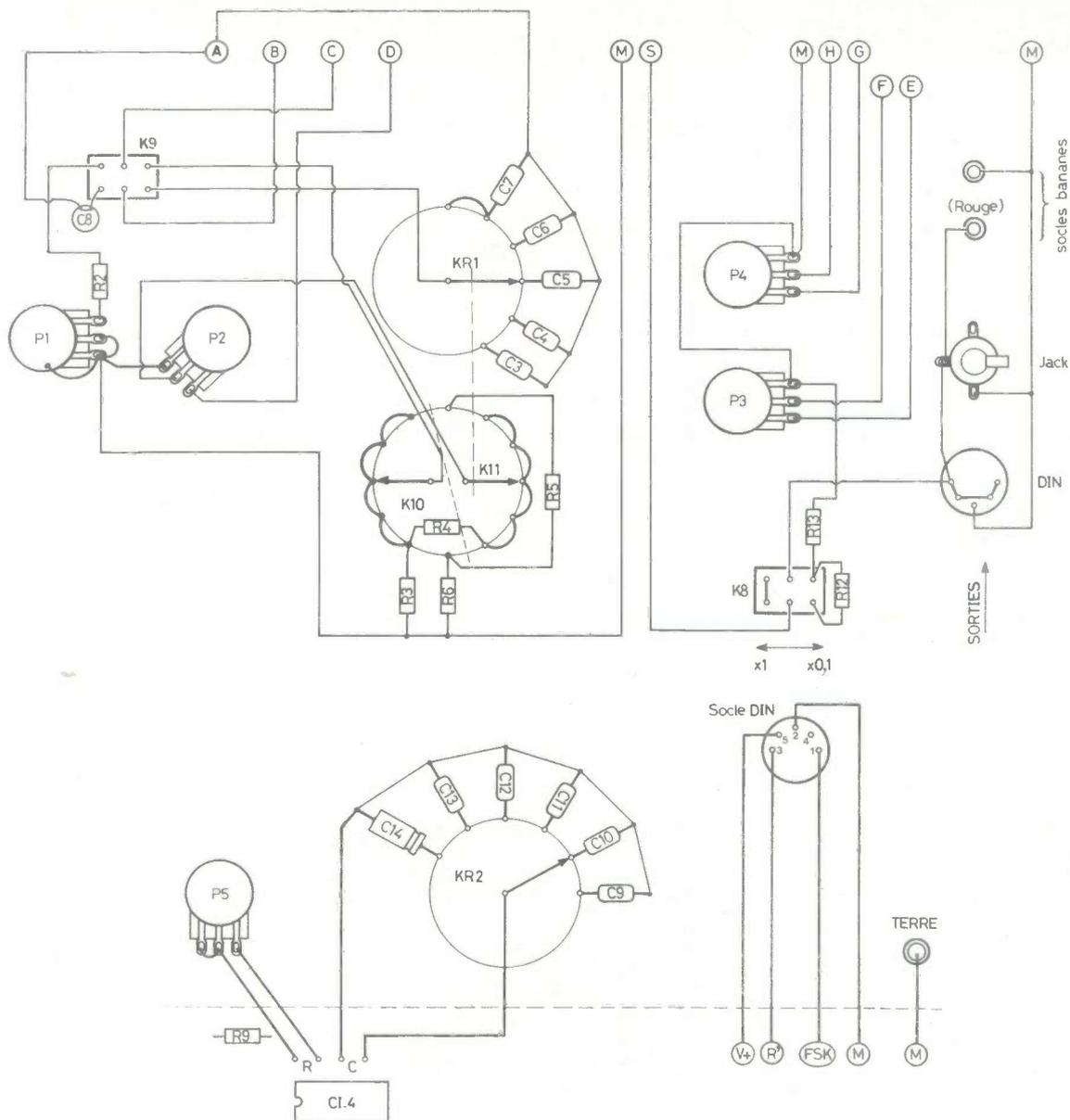
Fig. 5. et 6. - Câblage de la face avant vue de l'intérieur avec les raccordements aux cosses du circuit imprimé. La galette KR<sub>1</sub> rassemblant K<sub>10</sub> et K<sub>11</sub> doit être disposée côté tôle. Câblage du rotacteur KR<sub>2</sub>.
