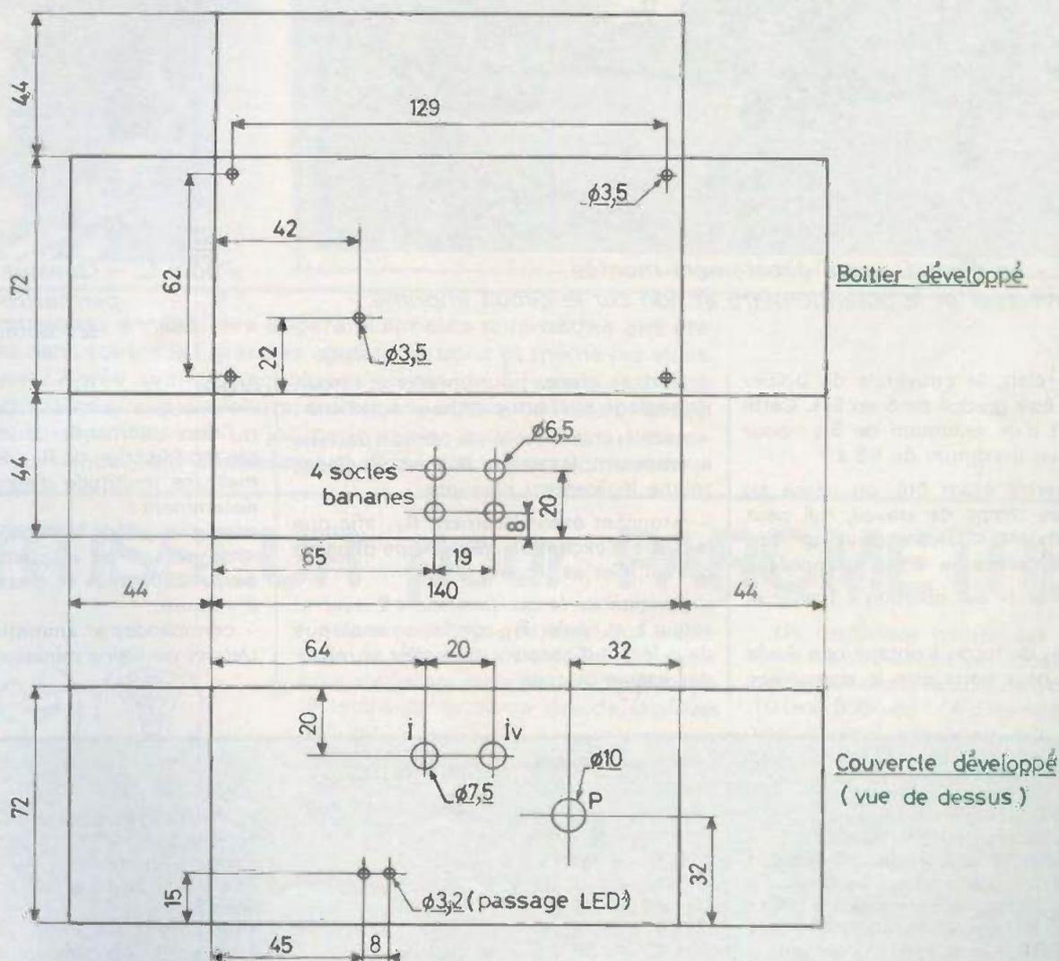
Fig. 6. - Le montage a été introduit à l'intérieur d'un coffret Teko 4/B de la série aluminium. Les divers plans de perçages sont donnés afin de faciliter le travail.
