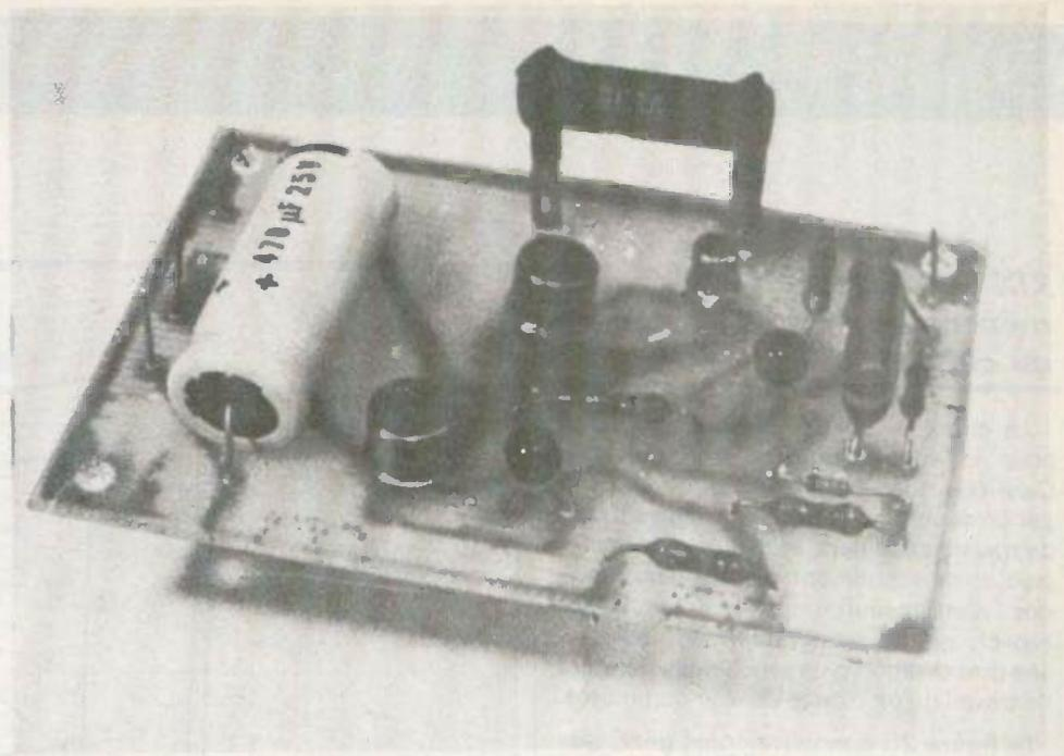
Photo 6. - Circuit imprimé du signal tracer.
