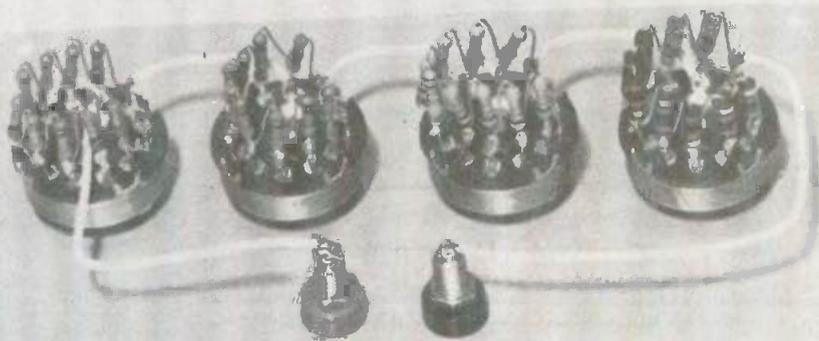
Photo A. - La disposition des résistances constituera un excellent exercice de câblage. En dépit de la simplicité du montage, on veillera, quand même, à la bonne mise en place des résistances.
