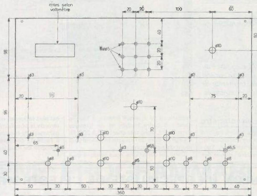
Fig. 25. - Plan de perçage complet du coffret et côtes selon le voltmetre employé.
