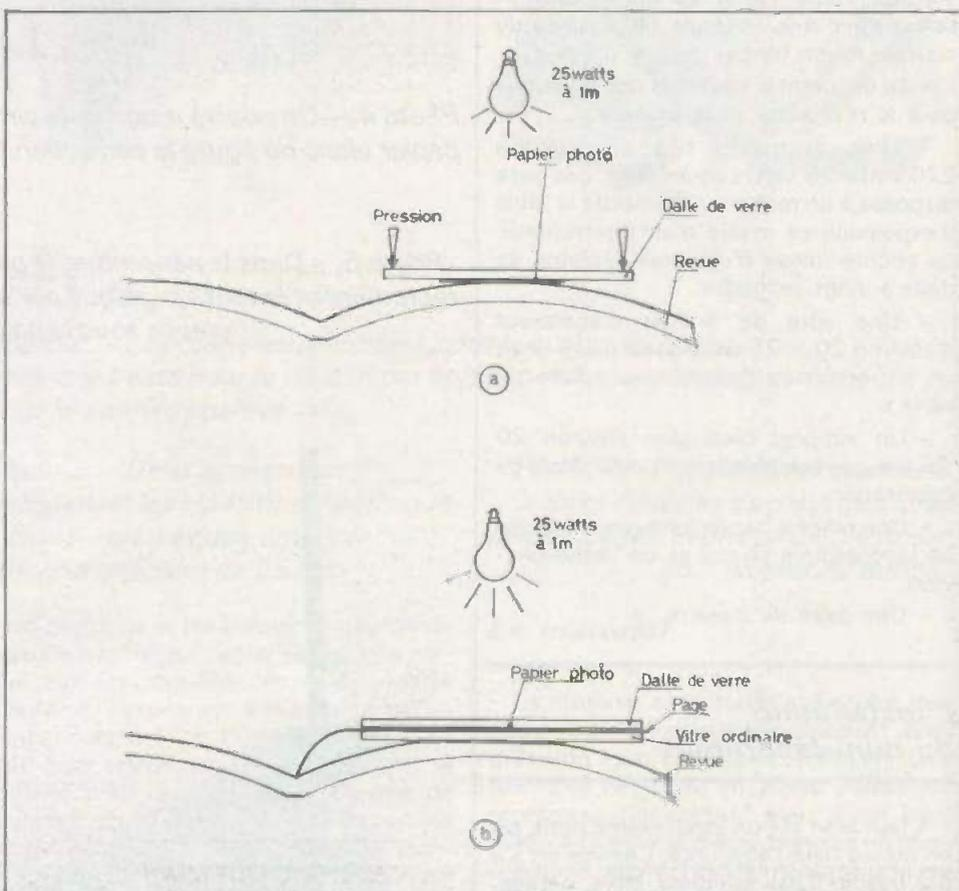
Fig. 1. - La feuille de papier photographique sera plaquée sur la page (a) en appuyant sur la dalle de verre, ou mieux encore en glissant une vitre plane sous la page (b).
