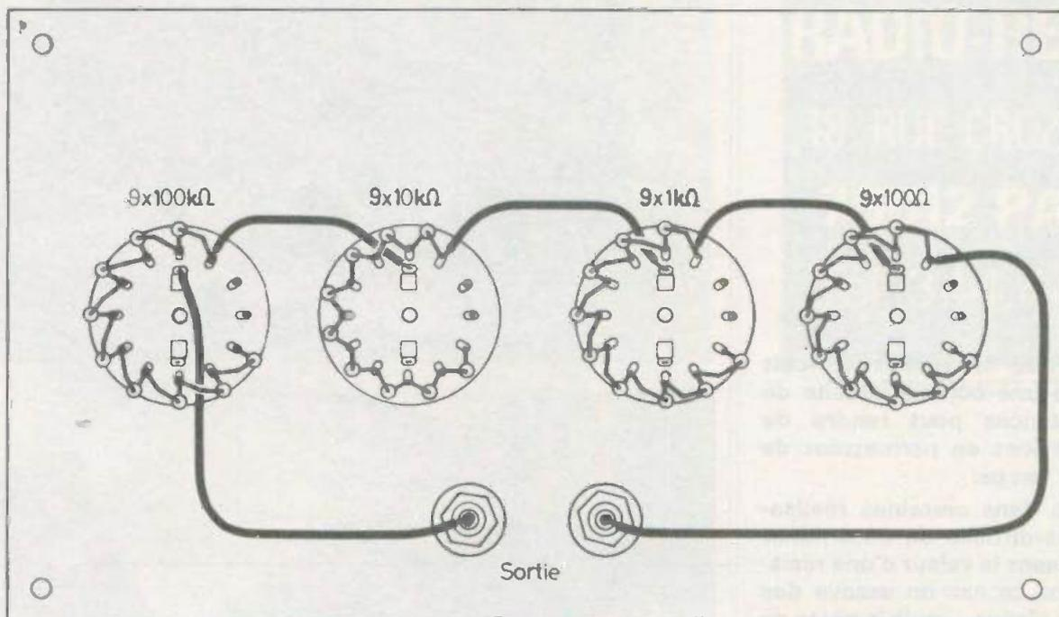
Fig. 2. - Plan de câblage général. Il ne sera pas nécessaire de disposer de supports. On exploitera directement les cosses de sortie des quatre commutateurs, ne prenant guère plus de place qu'un potentiomètre.
