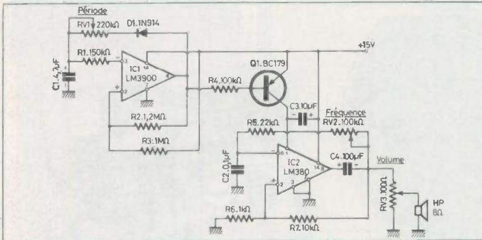
La tension d'alimentation est de + 15 volts et la consommation maximale de l'ordre de 100 mA.
