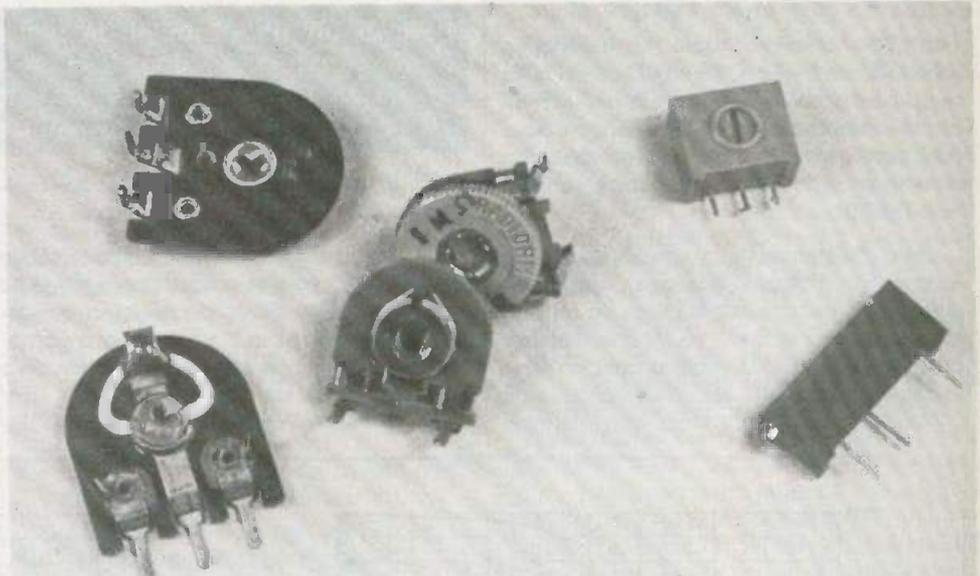
Photo 6. – Les potentiomètres ajustables sont prévus pour être soudés perpendiculairement ou parallèlement au circuit imprimé. A droite un trimmer 10 tours.
