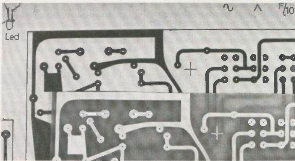
Photo 7. - Après attaque au perchlorure le restant de résine sensible est éliminée avec un cotar imbibé d'acétone.
