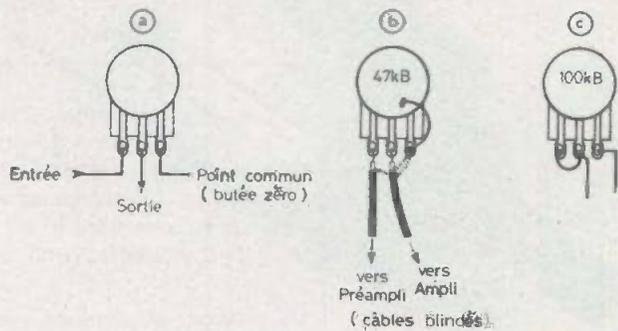
**Fig. 3. – Pour avoir une croissance de la tension de sortie en tournant le bouton dans le sens horaire, le point commun doit être relié en bas à droite.**
