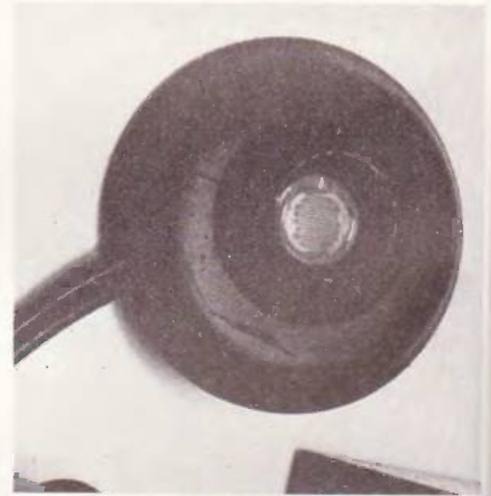
Photo 4. – Encapsulage de la cellule photo-résistive.
