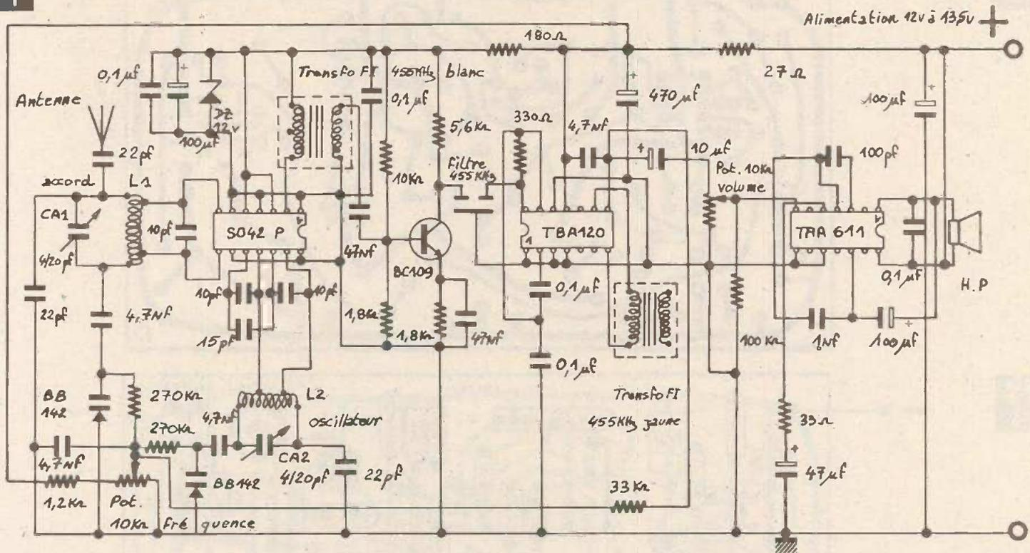
d'entrée. Un bobinage oscillateur  $L_2$  constitue le changeur de fréquence de ce montage ; il est également accordé par une varicap commandée par le potentiomètre de 10 k $\Omega$  de recherche des stations.
