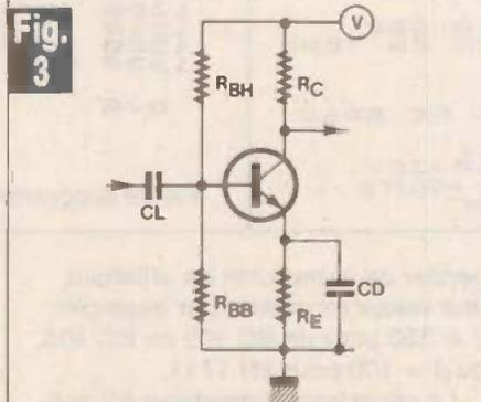
Calcul d'un étage à transistor par le Basic.
