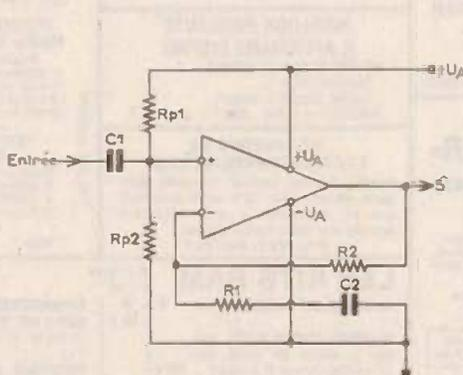
**Exemple complémentaire à celui de A 501 :** Un bon compromis entre stabilité et forte résistance d'entrée sera obtenu en prenant  $R_{P1} = R_{P2} = 220 \text{ k}\Omega$ , d'où  $C_1 \geq 15 \text{ nF}$ . Comme on avait  $R_1 = 10 \text{ k}\Omega$ , on devra prendre  $C_2 \geq 15 \text{ nF}$ . Comme on avait  $R_1 = 10 \text{ k}\Omega$ , on devra prendre  $C_2 \geq 330 \text{ nF}$ .
