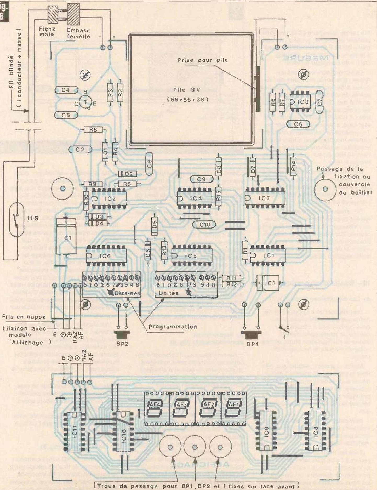
tifs ; ainsi, le nombre 0012 sera simplement affiché 12, grâce à une entrée « RIPPLE BLANKING IN » relié à la sortie « RIPPLE BLANKING OUT » du compteur suivant.
