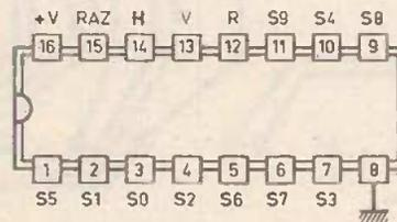
Le compteur "avance" au rythme des fronts montants du signal d'entrée appliqué en H (Horloge) à condition que l'entrée de validation V soit soumise à un état bas, si cet état est haut le compteur se bloque. Toute impulsion positive sur l'entrée RAZ assure la remise à zéro du compteur.
