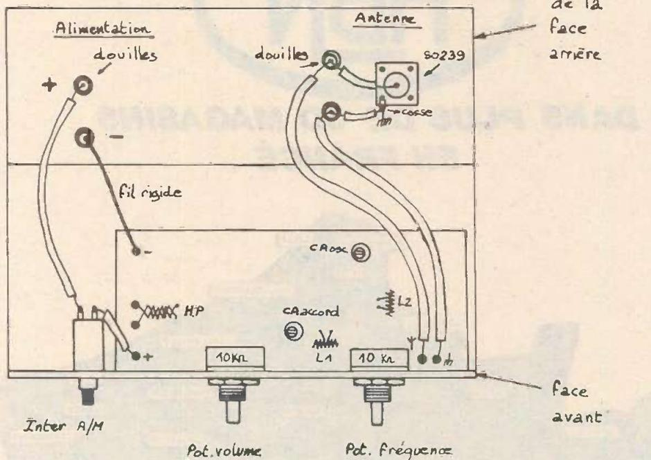
Le câblage des composants extérieurs au circuit imprimé s'effectue par des fils très courts en utilisant du fil rigide (chutes de résistances) afin de maintenir solidement le circuit et le boîtier.
