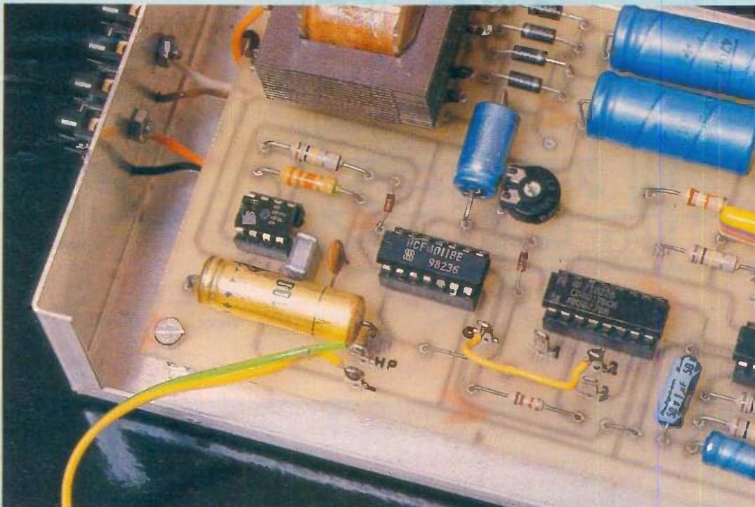
Photo 2. - Gros plan sur le circuit SAB 0600.
