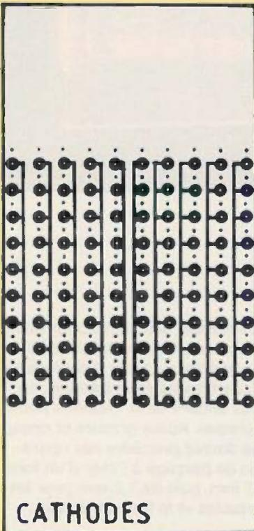
Les deux circuits imprimés, destinés à la mise en place des LED (voir texte).
