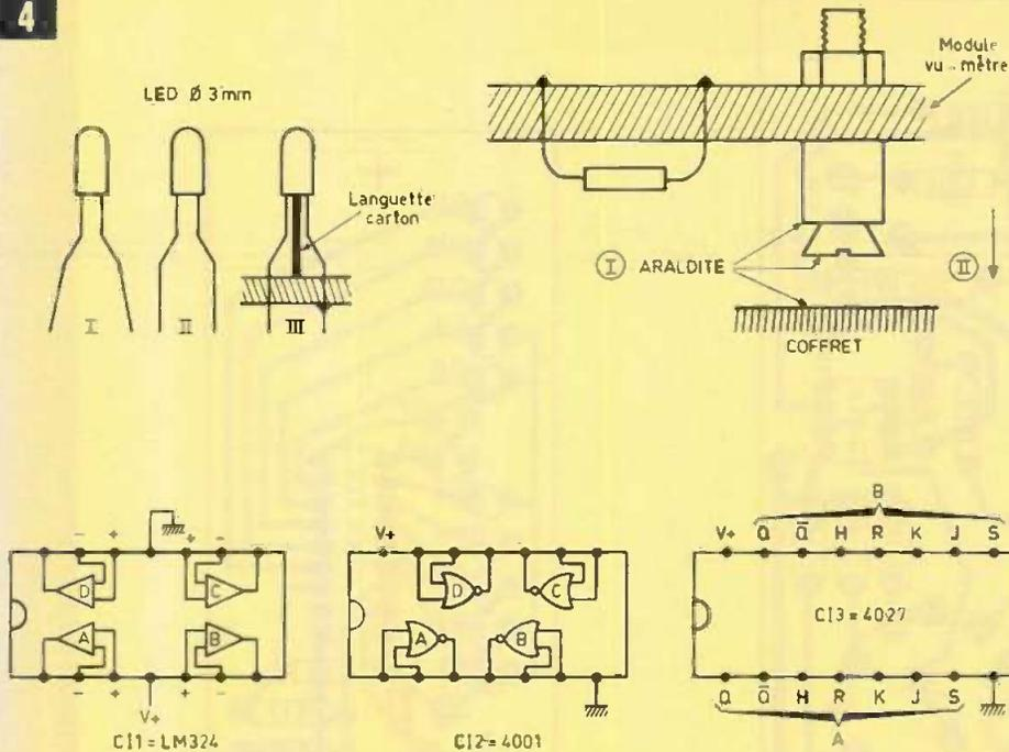
**Détails de montage des diodes LED et mise en place de la carte imprimée. Brochages des circuits intégrés.**
