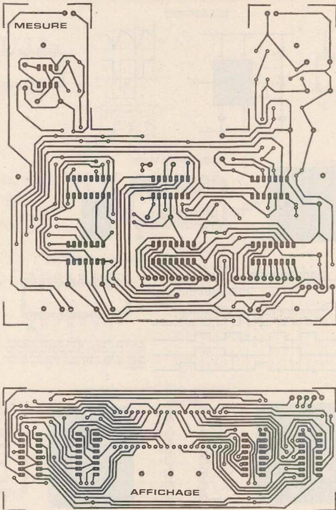
Les tracés des circuits imprimés, publiés grandeur nature, se reproduiront par le biais de la méthode photographique et à l'aide d'Epoxy présensibilisé. Côté implantation, présence de nombreux straps.
