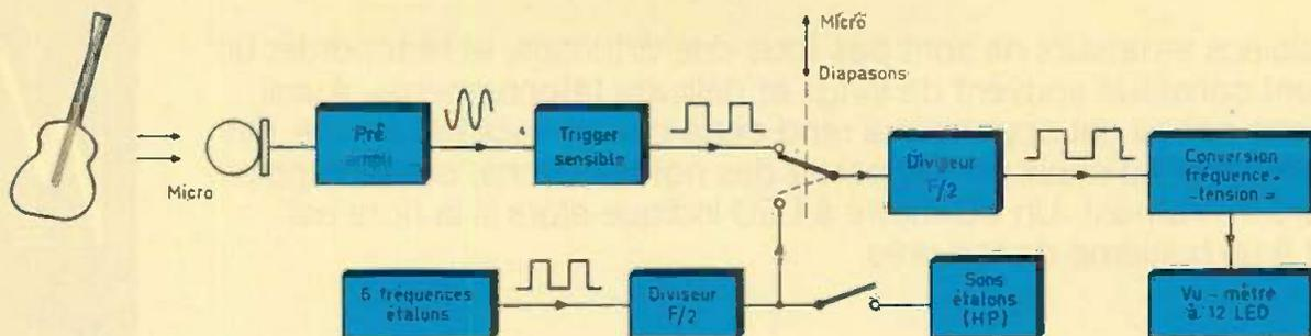
**Le synoptique du montage laisse apparaître trois sections principales !**
