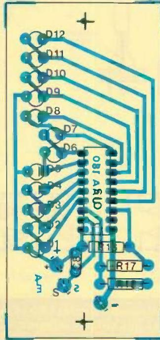
Les traces des circuits imprimés se reproduiront facilement même à l'aide de transferts direct Mecnorma. On veillera à la bonne implantation des différentes diodes LED.
