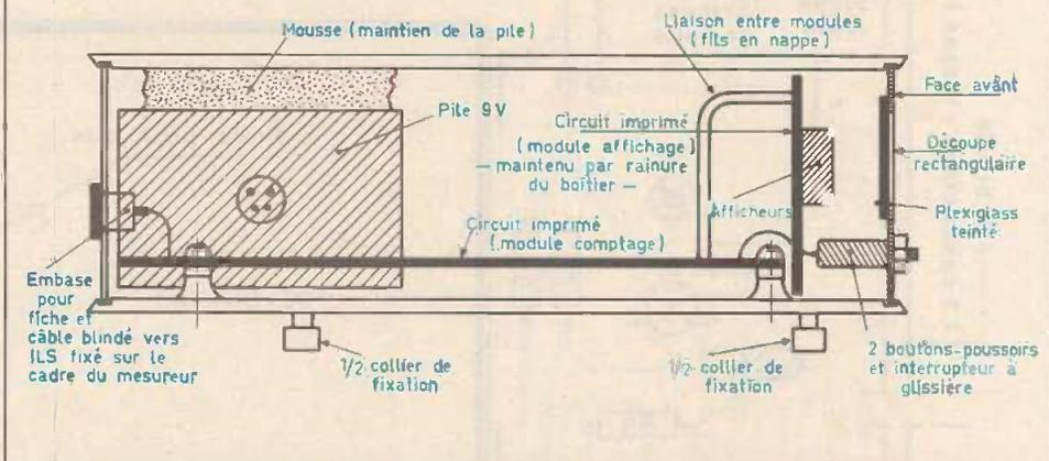
Détails de montage des cartes imprimées à l'intérieur du coffret.
