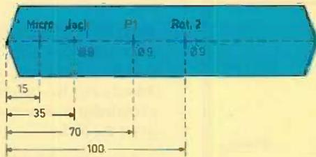
**Plan de perçage de la face avant en aluminium du coffret.**
