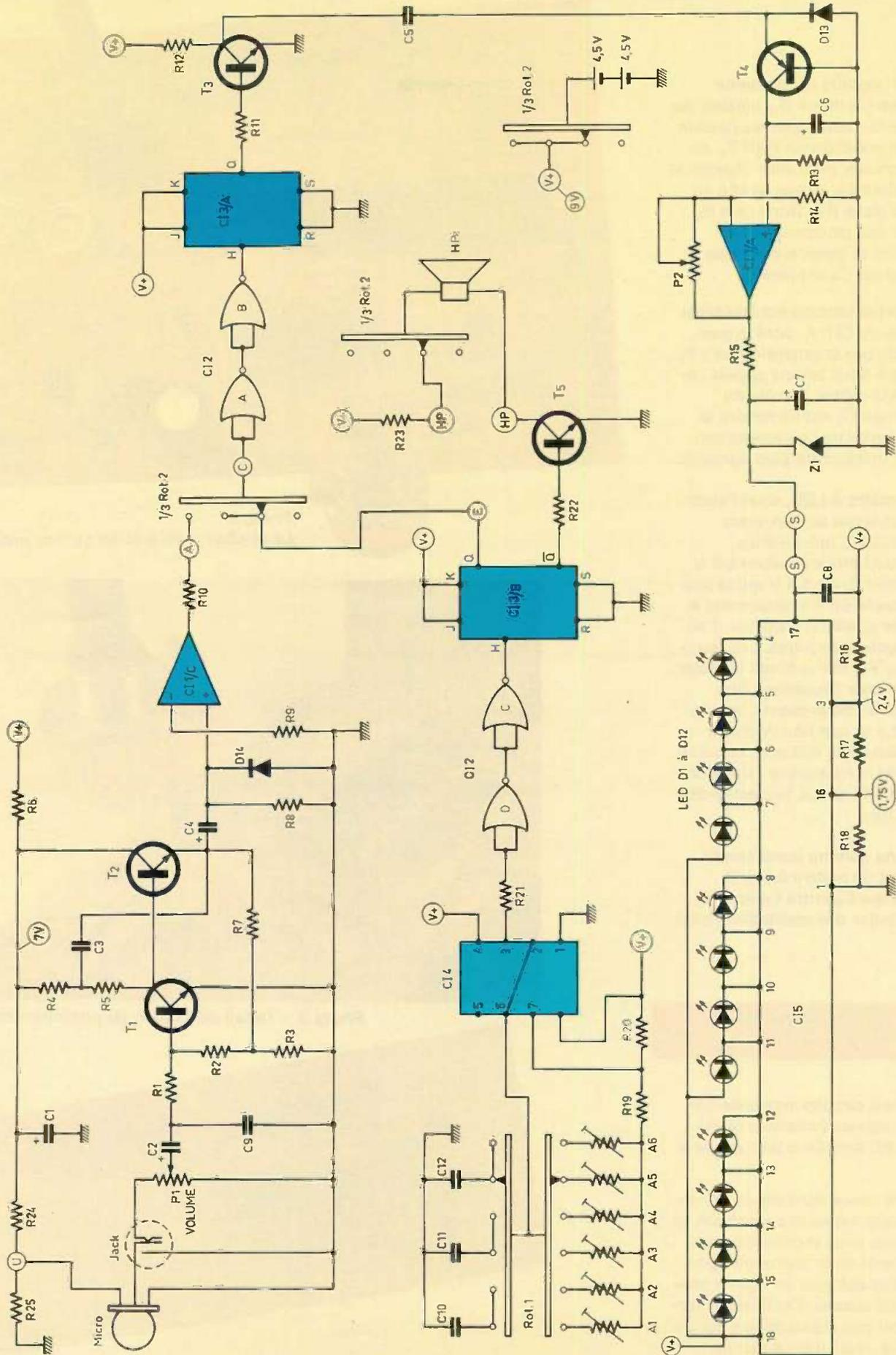
positifs et négatifs de **surfaces constantes** ; la diode  $D_{13}$  élimine les pics négatifs, tandis que les positifs traversent le transistor PNP  $T_4$ , en base commune, pour aller charger le condensateur  $C_6$ , lequel tend à se décharger dans  $R_{13}$ . Donc plus la fréquence des pics positifs est grande, plus la tension continue d'équilibre sur  $C_6$  est élevée.
