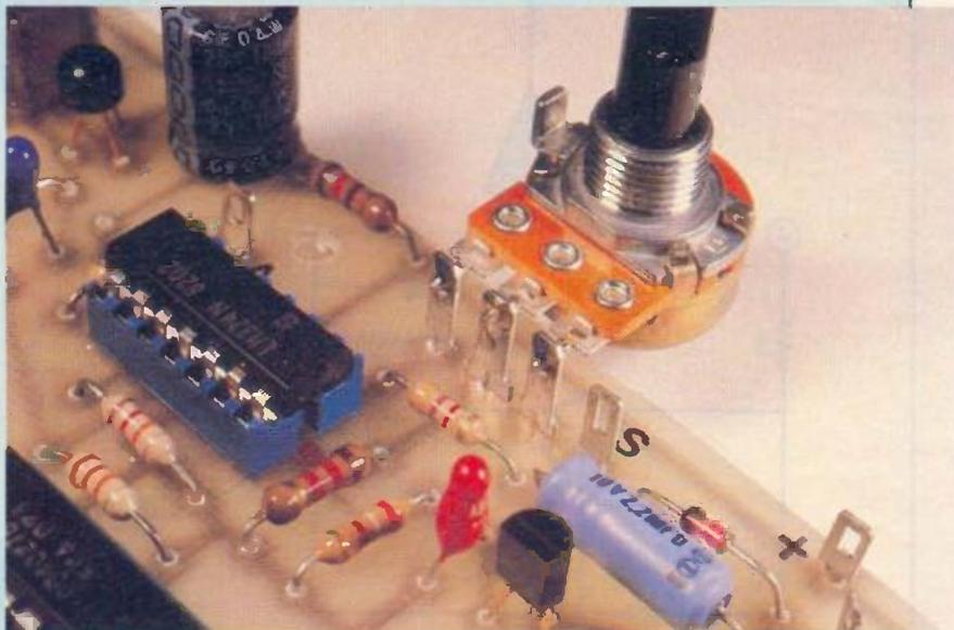
Photo 3. - Détail de fixation du potentiomètre  $P_2$ .
