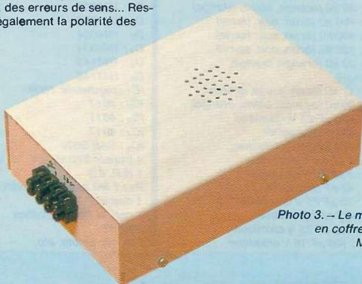
Photo 3. - Le montage en coffret Retex Minibox.
