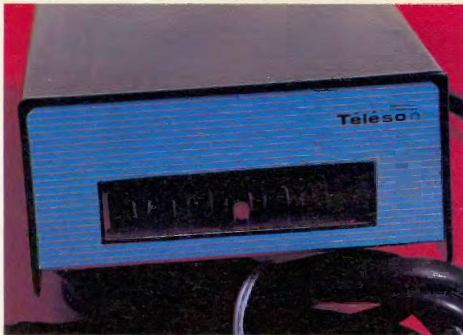
Un boîtier Retex abrite la réalisation.
