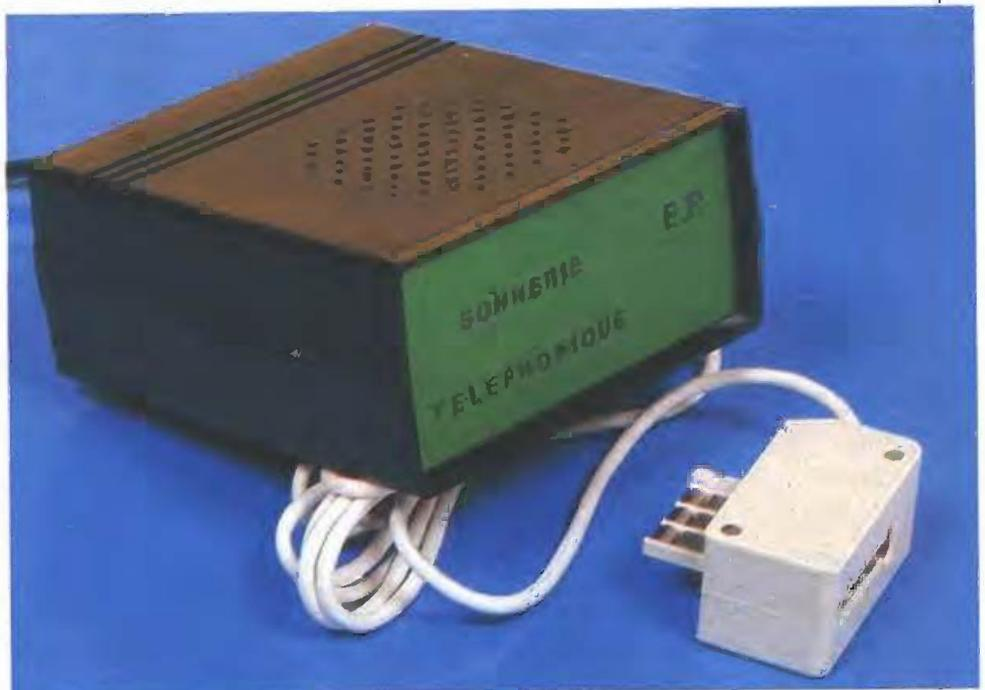
porte ce que nous connaissons tous, la tonalité. Bien entendu, le signal qui nous intéresse est celui de l'appel. En se référant au synoptique présenté à la figure 1, nous voyons que lorsqu'il arrive sur la ligne téléphonique, il est d'abord détecté, puis transformé par l'étage utilisant un photocoupleur. Ce
