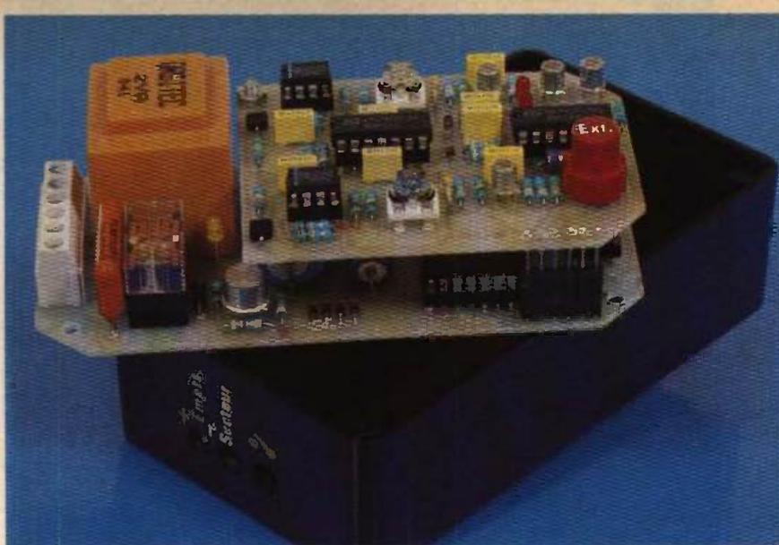
Photo 7. - Superposition des deux cartes imprimées.
