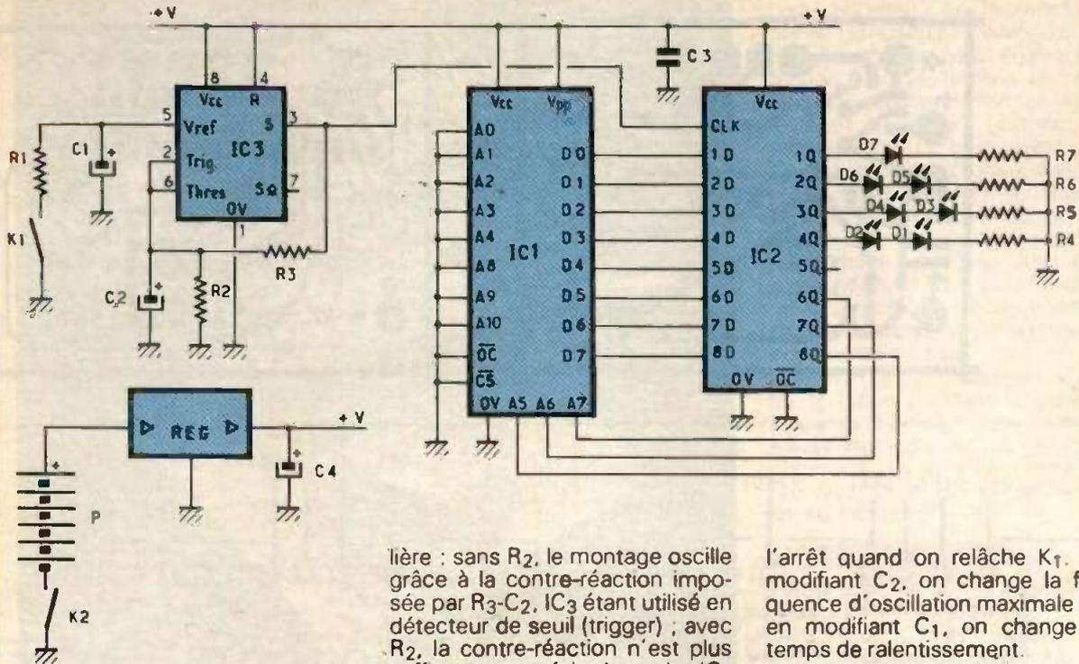
original en apparence, est en fait très réaliste (application directe de l'analyse de conception séquentielle) et moderne. Il suffit de modifier l'EPROM pour modifier le cycle et les informations décodées.
