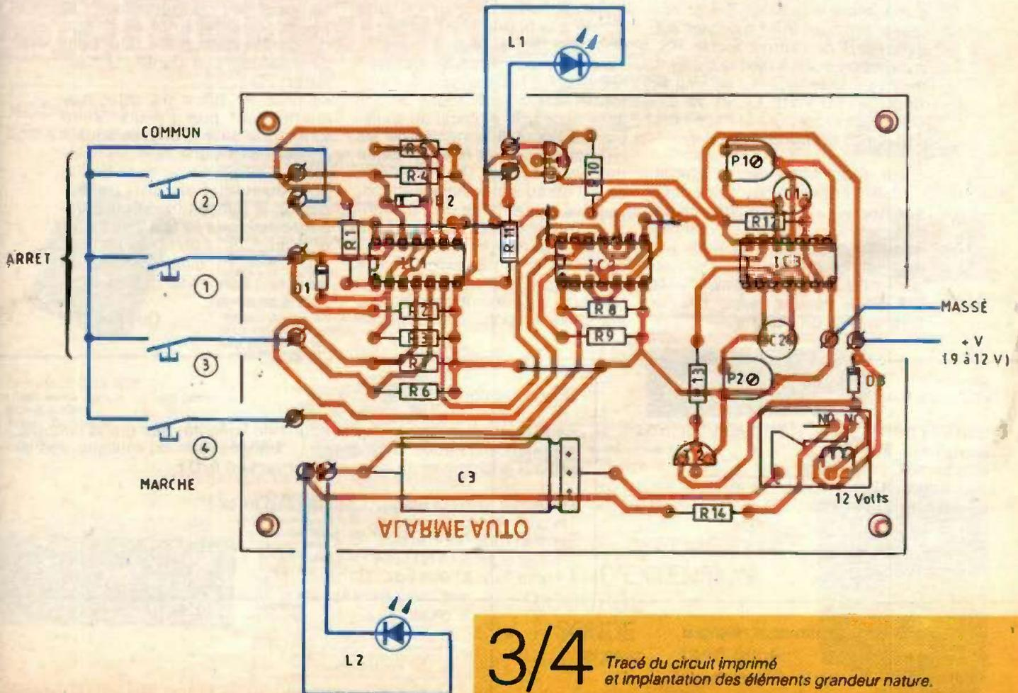
3/4 *Tracé du circuit imprimé et implantation des éléments grandeur nature.*
