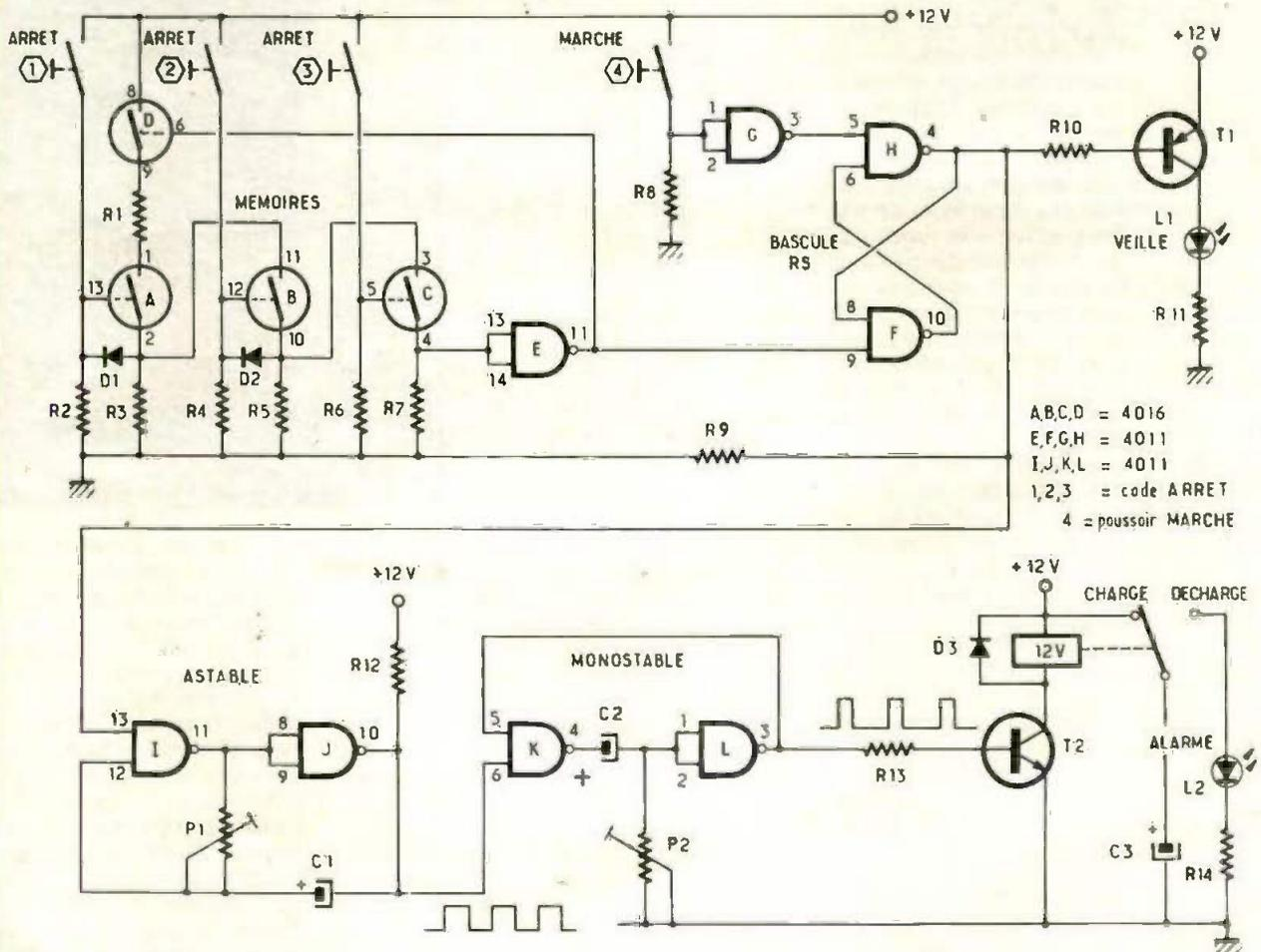
accumulée dans le condensateur peut s'effectuer brutalement dans la LED L<sub>2</sub>, avec une faible résistance de valeur R<sub>14</sub>. Nous avons choisi une diode LED à haute luminosité qui délivre envi-
