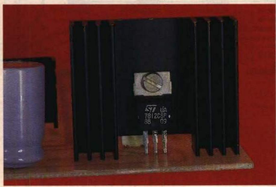
Photo 3. - Le régulateur de tension IC<sub>1</sub> sera monté sur un radiateur à ailettes.
