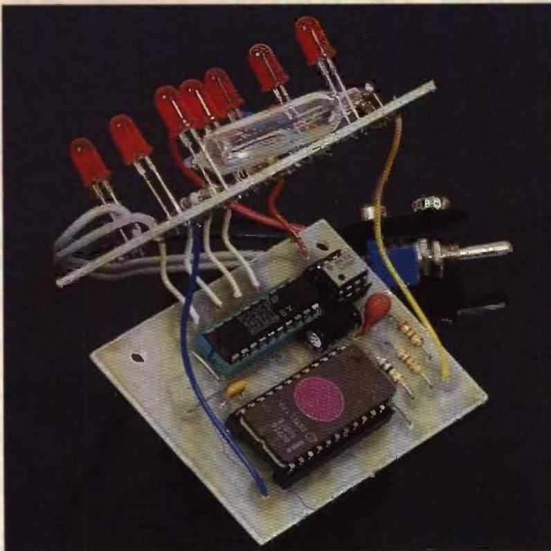
Photo 3. — Liaisons entre les deux circuits imprimés.
