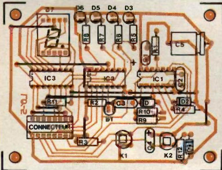
Photo 3. - Le circuit imprimé, côté cuivre.
