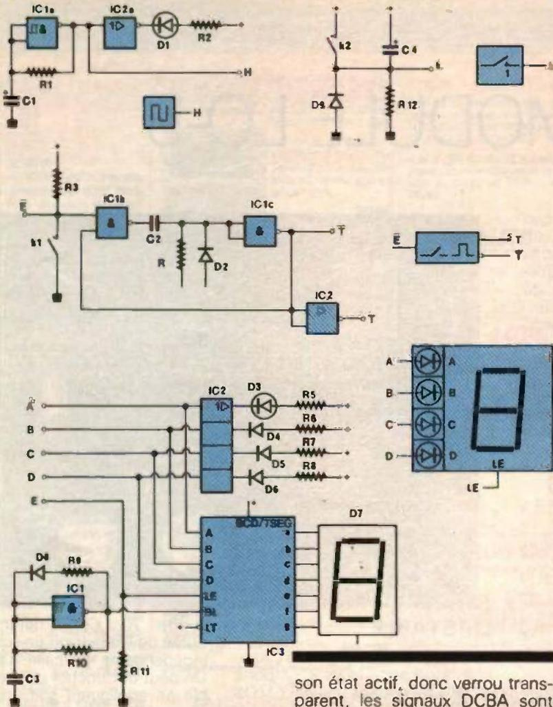
vers de portes NON d'isolation et d'amplification en courant. Ces mêmes entrées sont connectées à IC3, 4511, qui assure le décodage BCD pour commander un afficheur sept segments à DEL. Il n'y a pas de résistances de limitation du courant dans les DEL car on effectue une commande 'PWM' en contrôlant l'entrée d'effacement (/BL) du 4511 par un signal rectangulaire (fréquence supérieure au seuil de l'œil, rapport cyclique réglant le courant moyen de sortie). L'entrée LE est polarisée par R11 à
