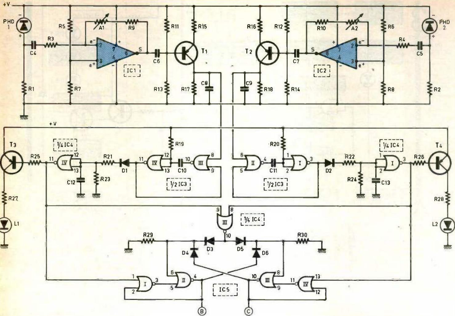
un potentiel nul en l'absence de signal. En revanche, lorsque PHD<sub>1</sub> est frappé du rayonnement infrarouge en provenance de l'émetteur, on enregistre, sur le collecteur de T<sub>1</sub>, des impulsions positives très brèves, espacées de 1,4 ms. La porteuse de 40 kHz a en effet été intégrée par la capacité C<sub>8</sub>, si bien qu'elle a disparu du signal ainsi disponible.
