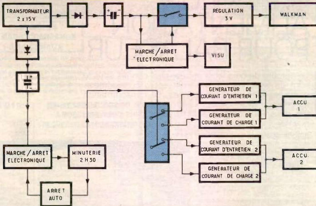
deux pour assurer le bon déroulement des opérations. Par ailleurs, nous avons opté pour un circuit de charge par accumulateur car ceux-ci, n'étant pas rigoureusement identiques électroniquement, peuvent perturber la charge lorsque l'on sait que deux cellules se rechargent théoriquement en série. Lorsque le chargeur est en fonction, les générateurs de courant constant de
