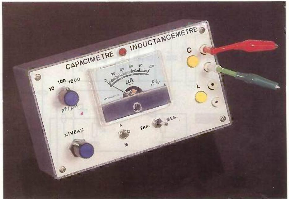
En faisant appel à une lecture analogique à caractéristique linéaire, on offre la possibilité de mesurer de très faibles valeurs de capacités ou de self inductance pour l'observation d'une variation relative. Cet avantage permet d'éliminer les erreurs dues aux cordons de mesure, par exemple.
