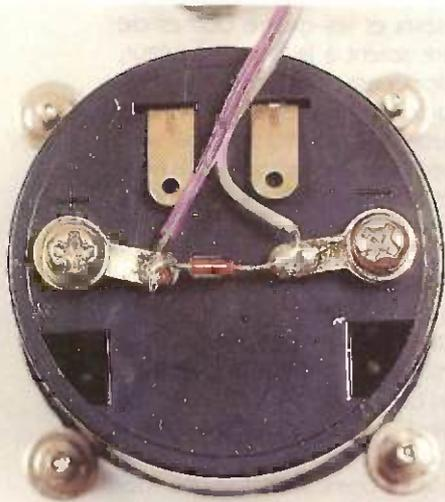
**VUE SUR D5, DERRIÈRE L'APPAREIL DE MESURE.**
