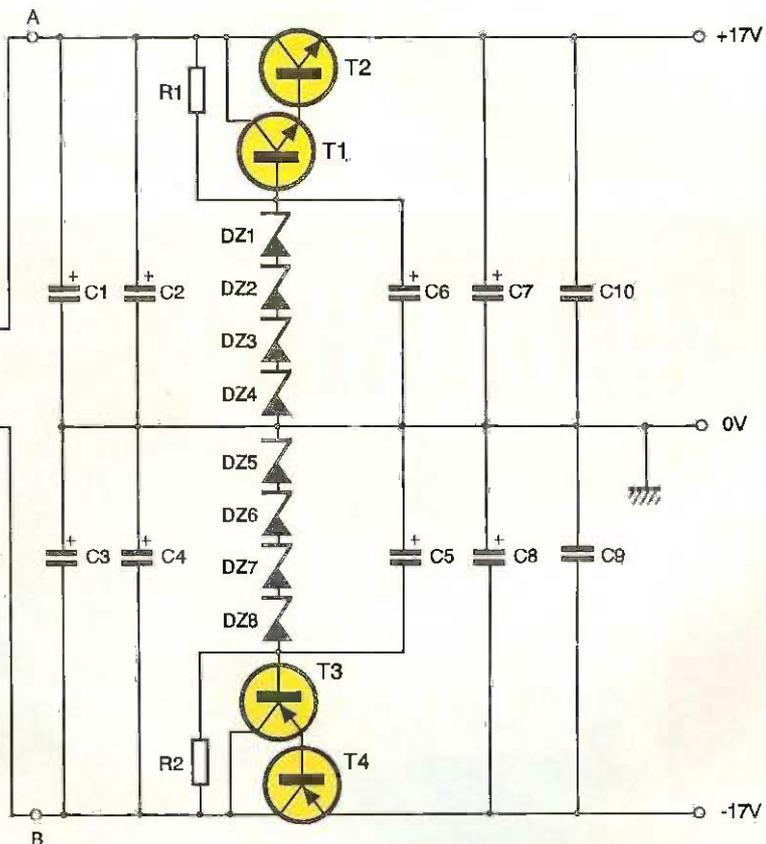
La tension de sortie est une nouvelle fois filtrée par les condensateurs  $C_9$  et  $C_{10}$  et par  $C_7$  et  $C_8$  qui servent de réservoirs d'énergie. Quelle puissance choisir pour notre transformateur ? Avec des haut-parleurs de  $4 \Omega$ , la puissance vaut  $4 \times I_2$ . Pour obtenir  $25 \text{ W}$ , il faut donc une intensité efficace  $I = 2,5 \text{ A}$ .
