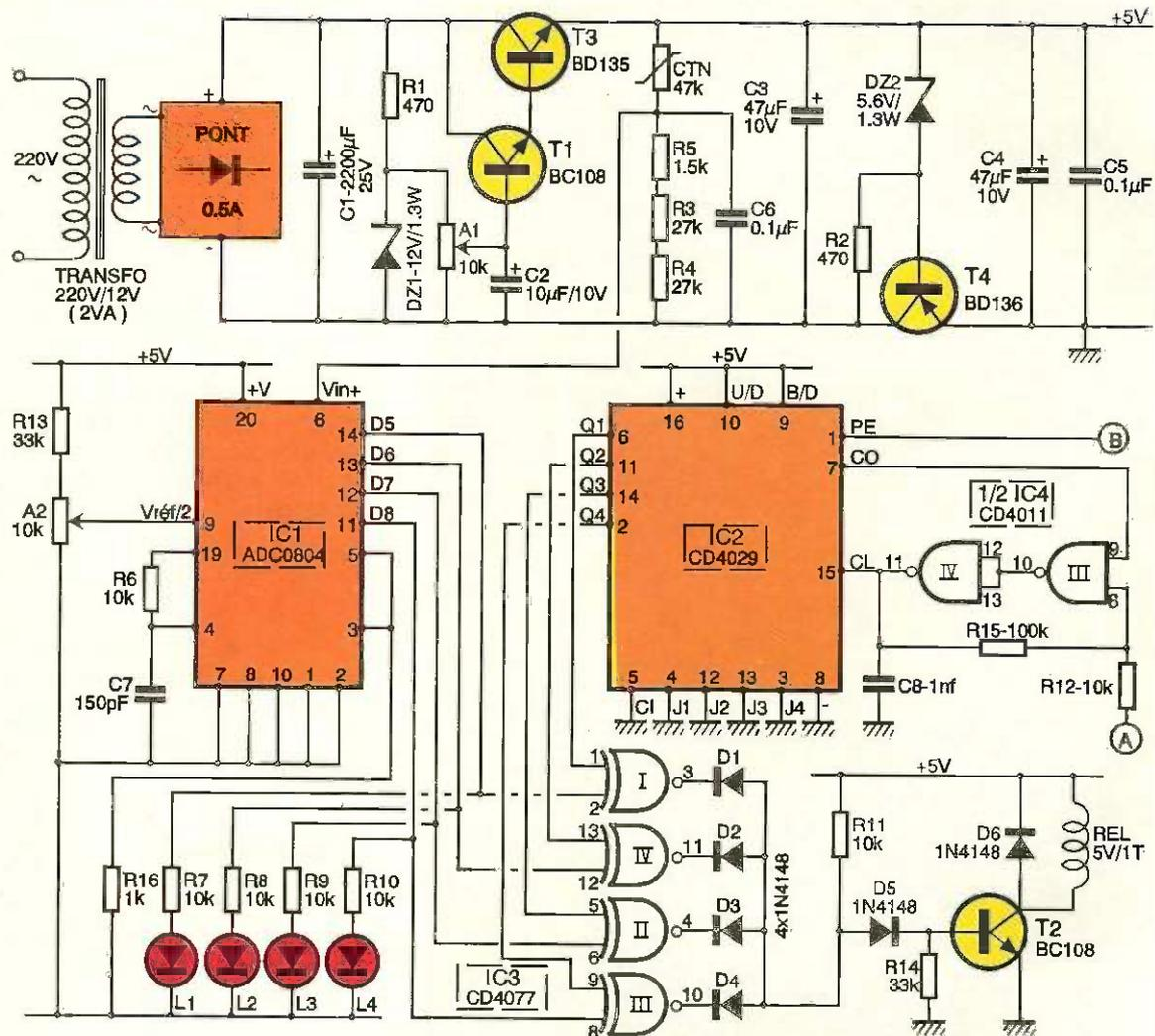
Le compteur avance au rythme des fronts montants des créneaux délivrés par le trigger de Schmitt évoqué au paragraphe précédent. Lorsqu'il atteint la position 15 (1111), la sortie CO (Carry Out) passe à l'état bas. De ce fait, le trigger se trouve neutralisé et le compteur reste bloqué sur cette position.
