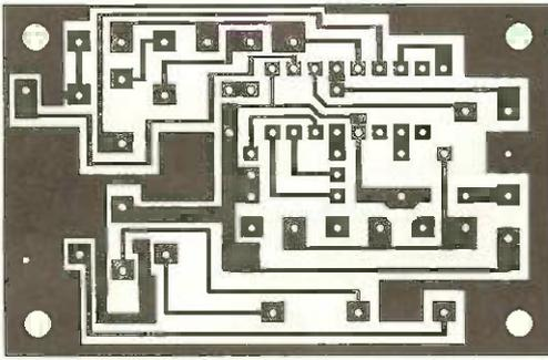
3 LE CIRCUIT IMPRIMÉ DU GÉNÉRATEUR SINUSOIDAL.
