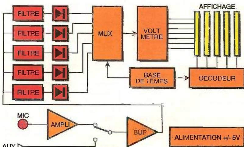
voltmètre, on active l'anode commune de la barre verticale correspondante grâce à un compteur décimal. Le découpage temporel du spectre permet de n'avoir qu'une barre lumineuse allumée à la fois, mais comme cela se fait à une fréquence supérieure à la persistance rétinienne, on a l'illusion que toutes les barres sont actives en même temps. On a donc besoin d'une base de temps et d'un compteur synchronisant la sélection du filtre relié au voltmètre et de la barre de LED validée.
