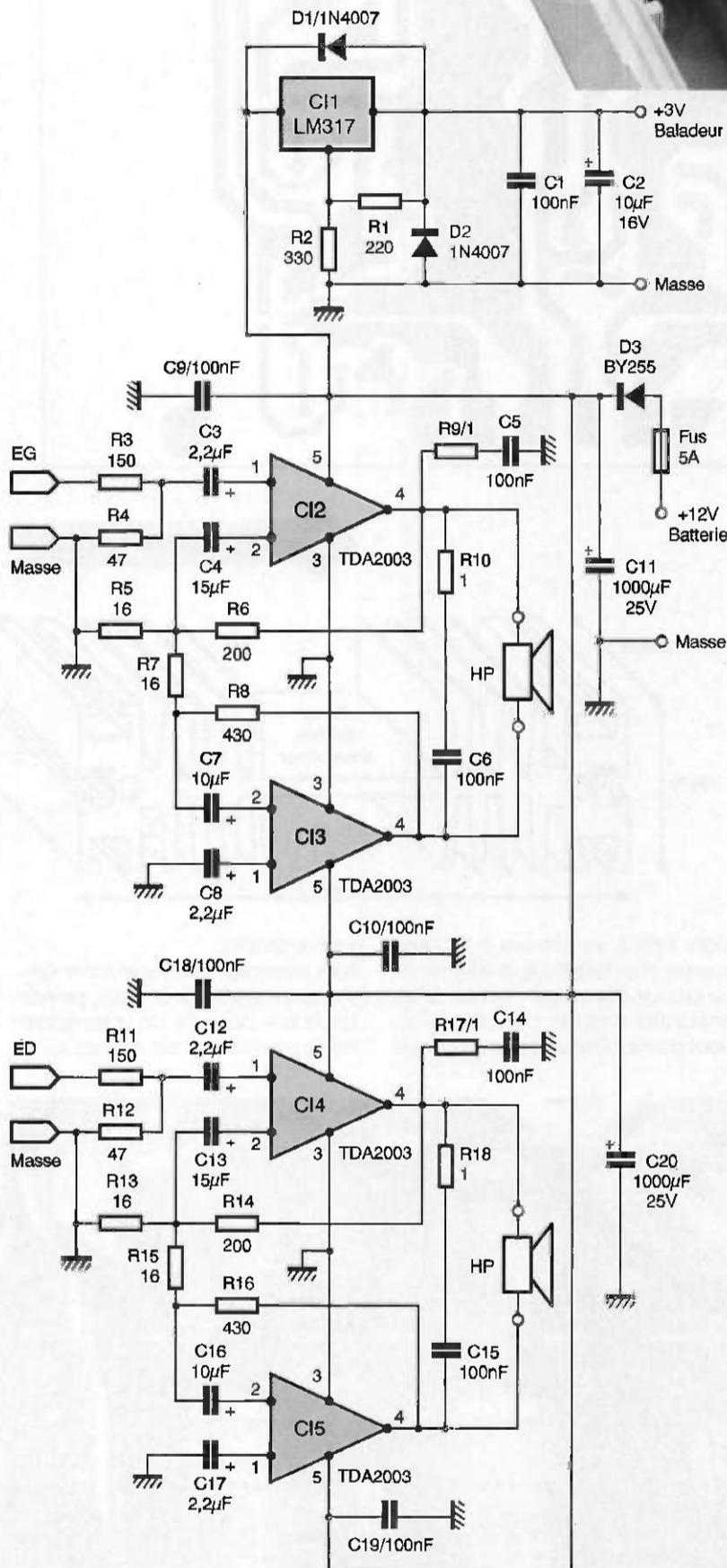
1 SCHÉMA DE PRINCIPE.
