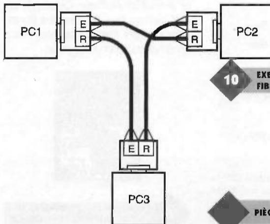
**10** EXEMPLE DE PSEUDO-RÉSEAU PAR FIBRE OPTIQUE (3 STATIONS).
