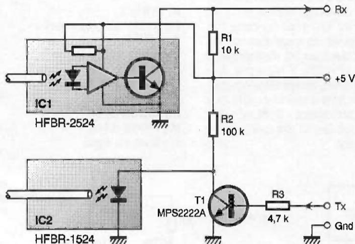
est le même que pour le récepteur : si Tx = 0V alors T<sub>1</sub> est bloqué donc IC<sub>2</sub> émet de la lumière, et si Tx = + 5V alors T<sub>1</sub> est saturé donc IC<sub>2</sub> est éteint. R<sub>2</sub> occupe également la fonction de pull-up tout en alimentant la diode d'émission de IC<sub>2</sub>. La valeur de R<sub>2</sub> fixe donc la portée. Quelques précautions sont à prendre pour son choix. R<sub>2</sub> est calculée de la manière suivante :
