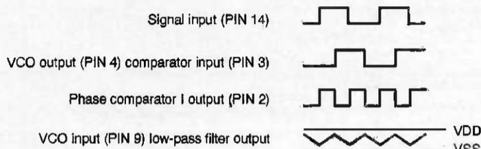
cycliques des entrées signal et comparateur ne sont pas importants puisque ce sont des transitions positives qui contrôlent les PLL utilisant ce type de comparateur.
