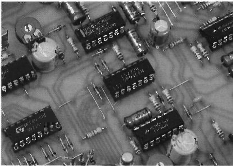
l'allumage de la LED  $L_2$ . On réglera l'ajustable  $A_1$  de façon telle que le relais reste fermé pendant une durée de l'ordre de 55 à 60 s. La durée augmente si on tourne le curseur dans le sens horaire.
