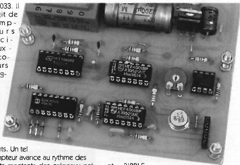
et « RIPPLE BLANKING OUT » entre compteurs consécutifs permettent de ne pas afficher les zéros non significatifs. Exemple pour la valeur 83 ce sera ce nombre qui sera visible aux afficheurs et non 083. L'entrée « RESET » doit être soumise à un état bas. Toute impulsion positive sur cette entrée a pour effet immédiat la remise à zéro du compteur. Dans le présent montage, cette remise à zéro peut être volontaire par appui sur le bouton poussoir BP.
