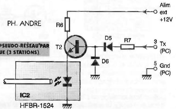
**11** SCHÉMA DE PRINCIPE DE LA PARTIE TRANSMISSION.
