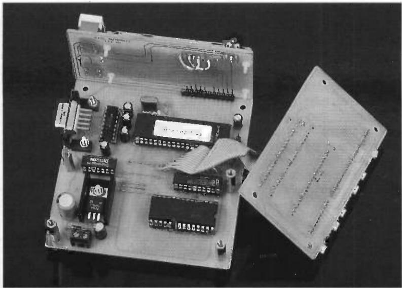
ment le 8052AH BASIC ne permet pas d'accéder aux ports 0, 2 et 3 directement à partir des instructions du BASIC. Seul le port P1 est accessible aux applications. Comme par ailleurs le signal INT0 sert à implémenter un DMA logiciel (Direct Memory Access), le bouton poussoir  $BP_1$  ne pourra pas être géré directement en BASIC.
