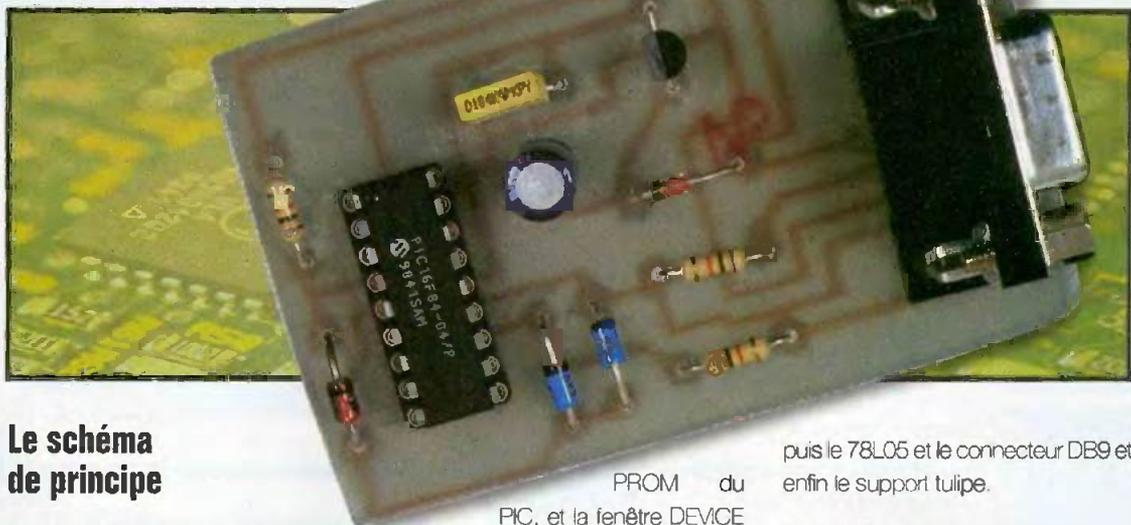
**Le programmateur que nous vous proposons est sûrement le plus petit en taille et en prix que l'on puisse trouver ! En effet, il ne se compose que de 10 petits composants passifs, pas d'alimentation extérieure et permet de programmer le PIC16C84 et PIC16F84 en quelques secondes.**
