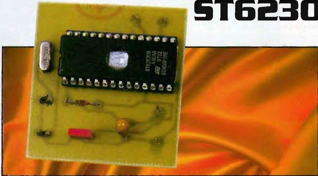
Dans cet article nous allons expliquer comment fonctionne le port de communication série asynchrone (U.A.R.T.) du microcontrôleur ST6230 de chez ST-Microelectronics et donner ensuite un circuit accompagné d'un programme pour gérer ce protocole.
