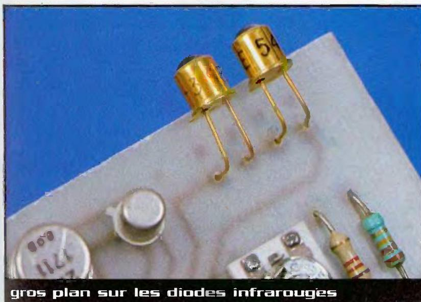
**gros plan sur les diodes infrarouges**
