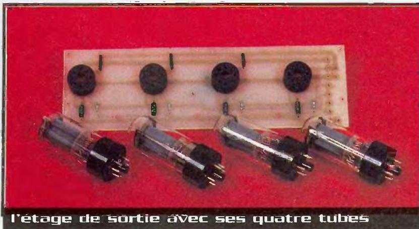
l'étage de sortie avec ses quatre tubes
