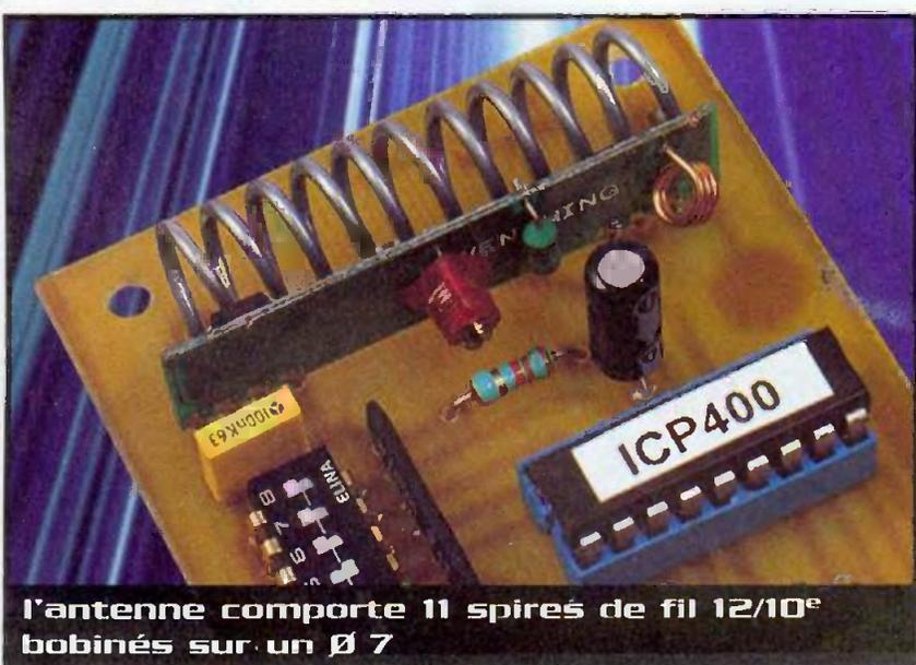
l'antenne comporte 11 spires de fil 12/10<sup>e</sup> bobinés sur un Ø 7
