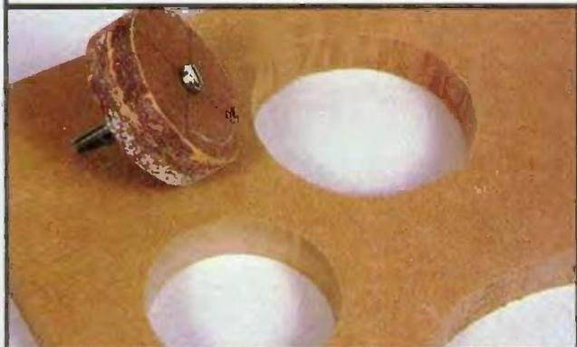
**La chute du trou de l'évent sur laquelle a été collé un abrasif sert à poncer le trou, le tube y entrera à force. Notez la différence d'état de surface du trou du tweeter.**
