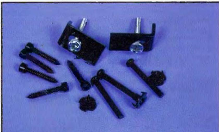
Trois systèmes pour la fixation des haut-parleurs. Les pattes, métalliques ou plastique, bloquent le haut-parleur contre la façade. Les haut-parleurs légers se contentent de vis à bois, ici des BTR à filets fins et profonds. L'écrou à frapper s'enfonce à l'intérieur de la face avant, la vis maintient le haut-parleur sur l'avant.
