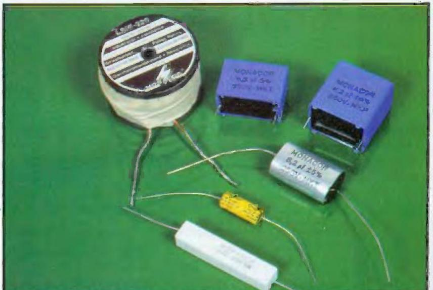
**Quelques composants pour filtres : self sur ferrite, condensateurs et résistances. Les quatre condensateurs présentés ici ont pratiquement la même valeur... Les bleus sont des MKT et MKP, le jaune un chimique non polarisé.**
