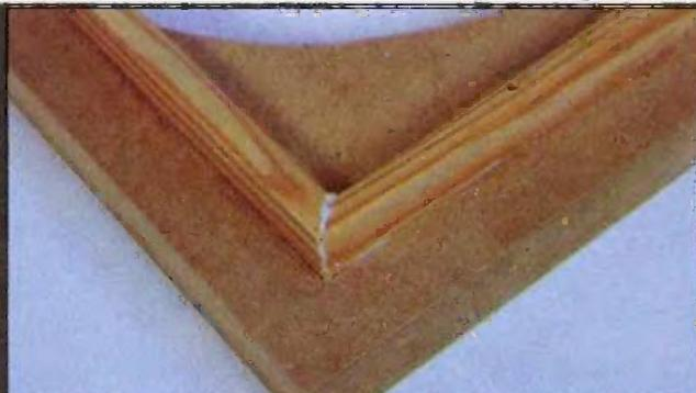
Les baguettes sont assemblées, collées et clouées, nous avons ici fait un assemblage à 45°, qui demande de la précision et de la patience s'il faut ajuster les baguettes.
