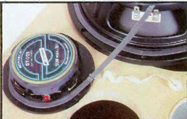
Avant la pose des haut-parleurs, on dépose un joint d'étanchéité, son papier de protection s'enlève au fur et à mesure de l'avance du collage.
