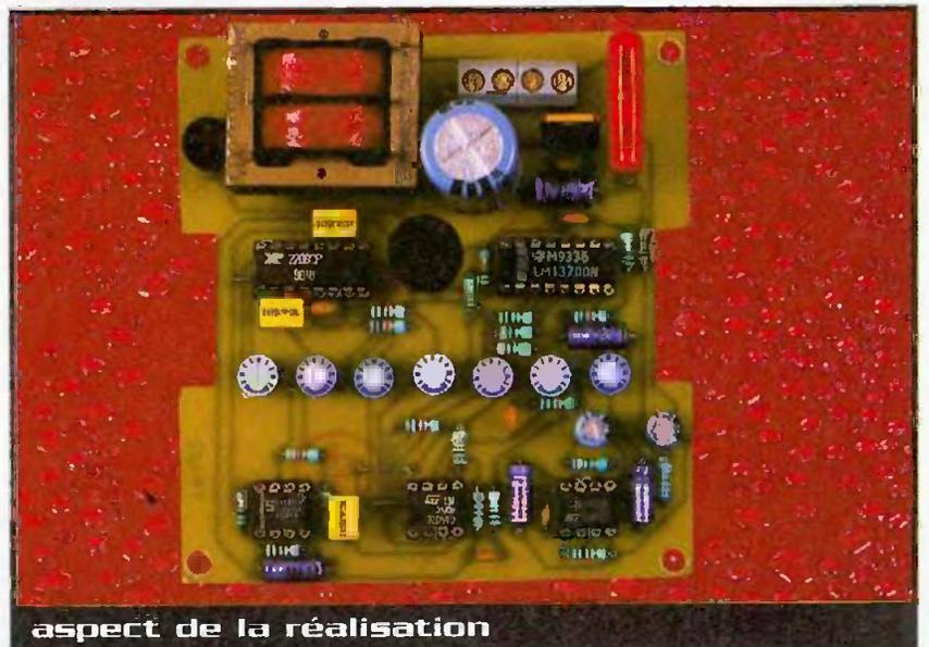
circuits intégrés, les ajustables et les capacités. Attention à l'orientation des composants polarisés. On terminera par les composants de plus grande épaisseur.
