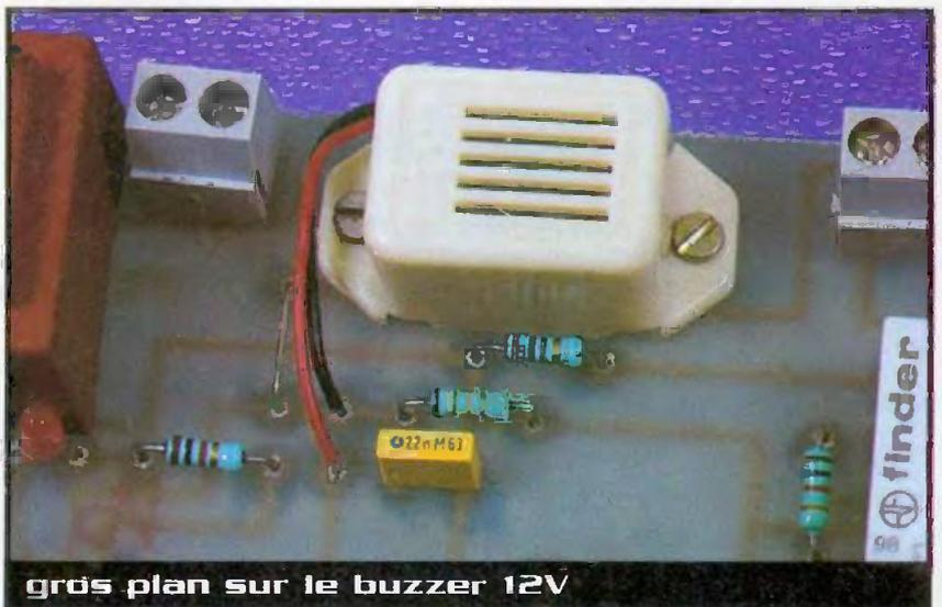
**grès plan sur le buzzer 12V**
