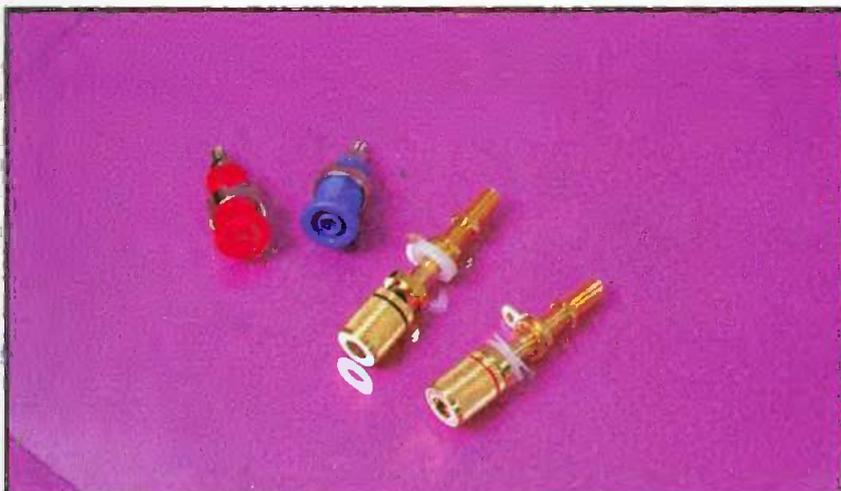
**Les bornes longues permettent une traversée de l'épaisseur du bois. Ce dernier est isolant, pas de problème. Les douilles présentées ici sont des modèles de sécurité, elles recevront des fiches banane, elles aussi de sécurité, donc entourées d'une gaine isolante.**
