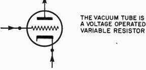
THE RESISTANCE OF THE TRIODE VACUUM TUBE IS VARIED BY CONTROLLING THE GRID VOLTAGE
