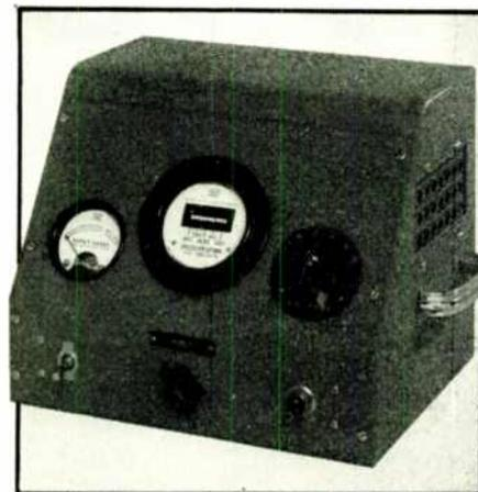
FIG. 3. VACUUM TUBE FREQUENCY METER
