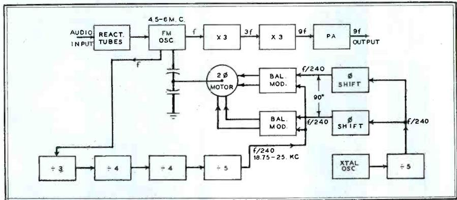
FIG. 8. BLOCK DIAGRAM OF THE EXCITER AND FREQUENCY-CORRECTING MOTOR
