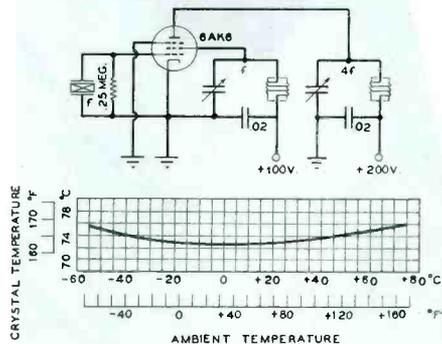
FIG. 2. BLILEY TEMPERATURE CONTROLLED CRYSTAL FOR MOBILE USE
