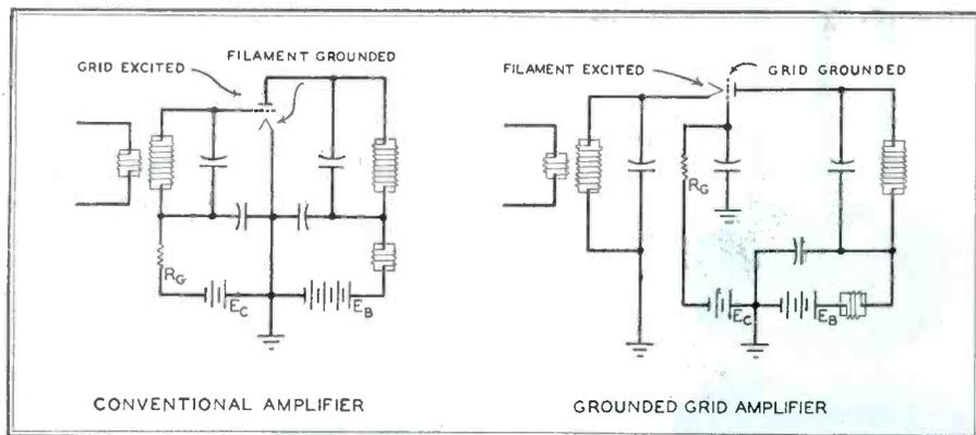
FIG. 10. COMPARISON OF THE CONVENTIONAL AND GROUNDED-GRID AMPLIFIER CIRCUITS
