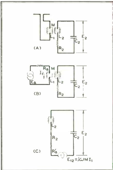
FIG. 9. TYPICAL INPUT CIRCUIT OF A RECEIVER SHOWING THE EQUIVALENT CIRCUITS USED FOR THE COMPUTATION OF THE SIGNAL VOLTAGE,  $E_2$
