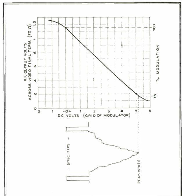
FIG. 7. CALIBRATION OF THE MODULATION PERCENTAGE
