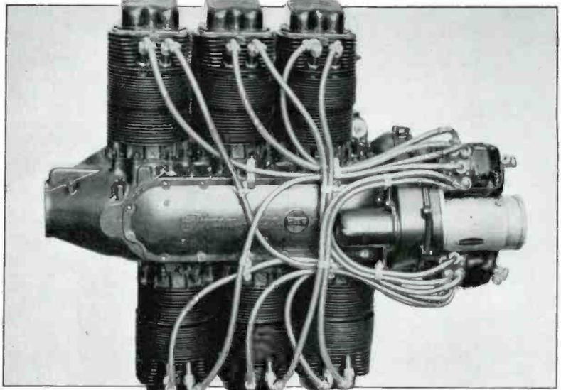
FIG. 3. A SIMPLER TYPE OF IGNITION SHIELDING IS USED FOR THE FRANKLIN ENGINE
