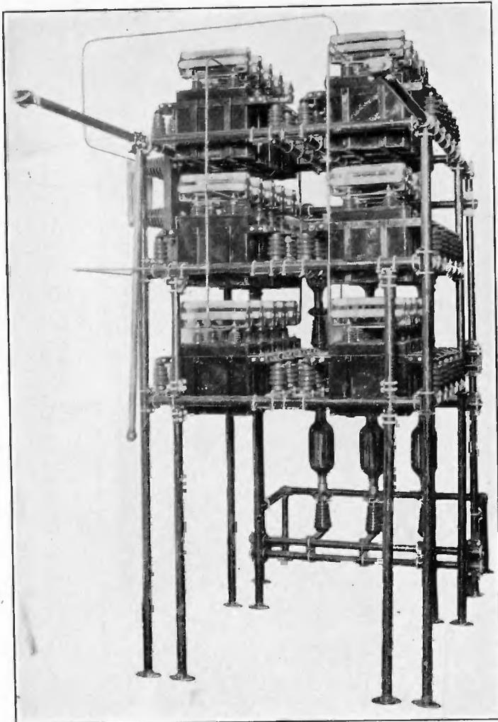
FIGURE 64—Kenotron Rectifier Unit
