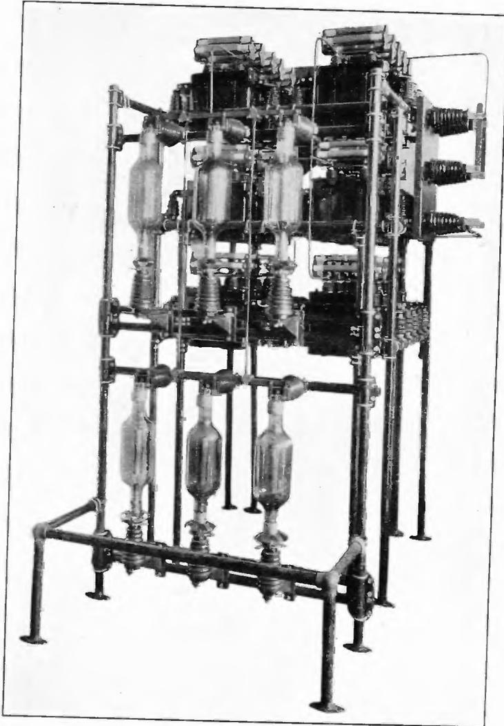
FIGURE 63—Kenotron Rectifier Unit
