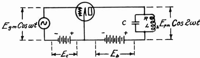
Fig. 1—Basic circuit.
