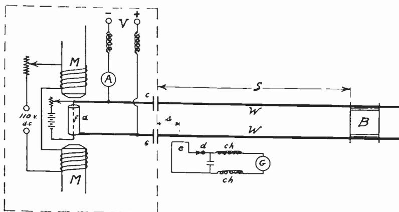
Fig. 2—Experimental circuit.
