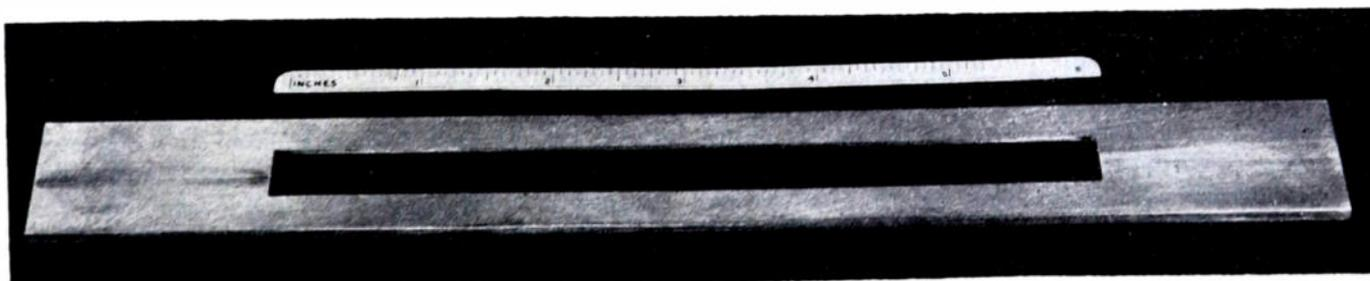
Fig. 6—Open slot coupling insert.
