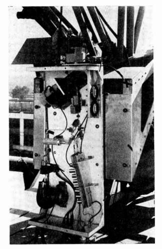
Fig. 3-4.3-mm radiometer.
