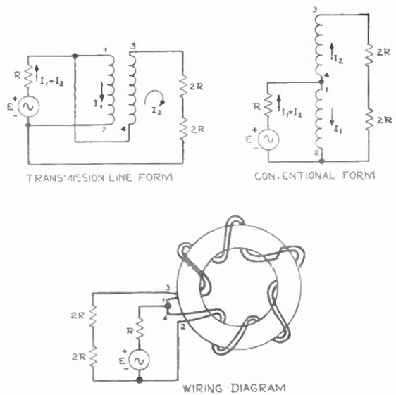
Fig. 3—4:1 Impedance transformer.
