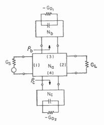
Fig. 7—The hybrid-type amplifier.
