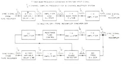
(b) LOCKED - OSCILLATOR YVPE RESAMPLER SYNCHRONIZER
