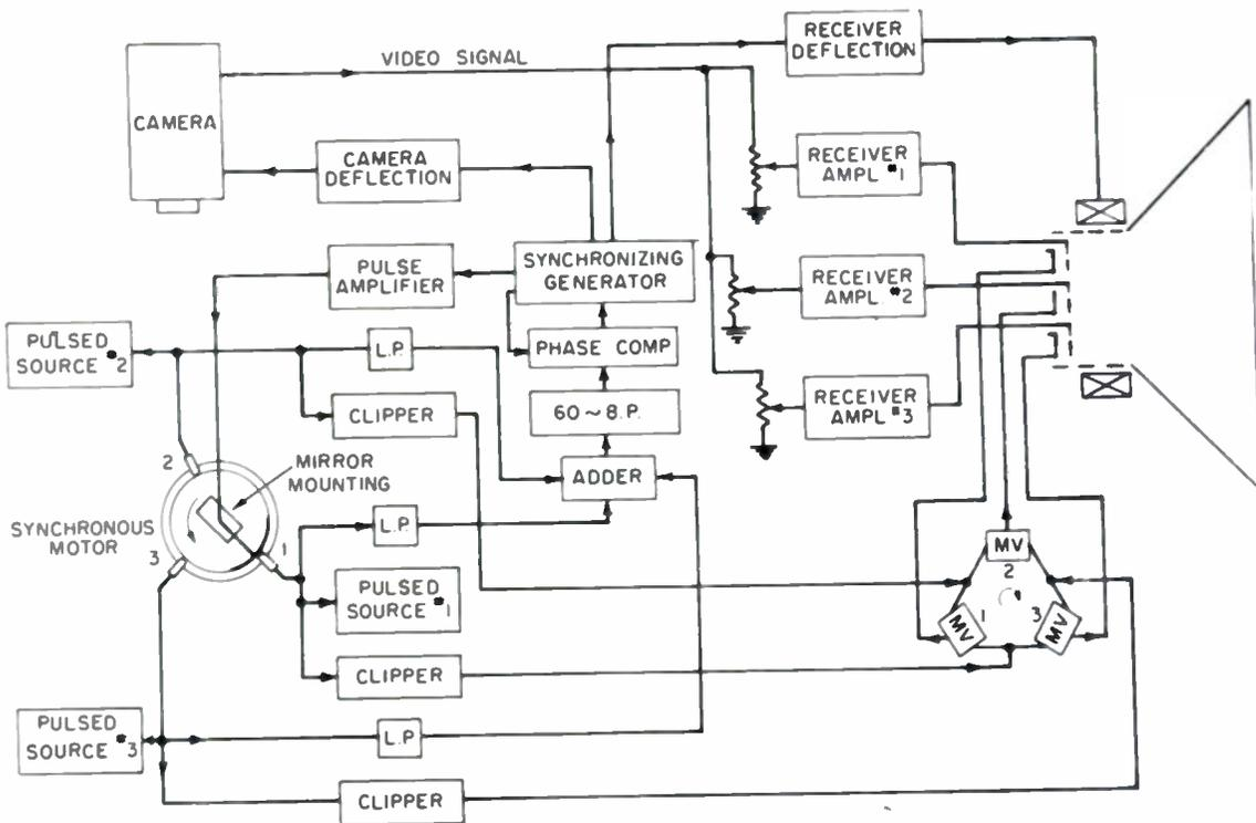
FIG. 6 — BLOCK DIAGRAM FOR COLOR TRANSLATING MICROSCOPE AT ROCKEFELLER INSTITUTE
