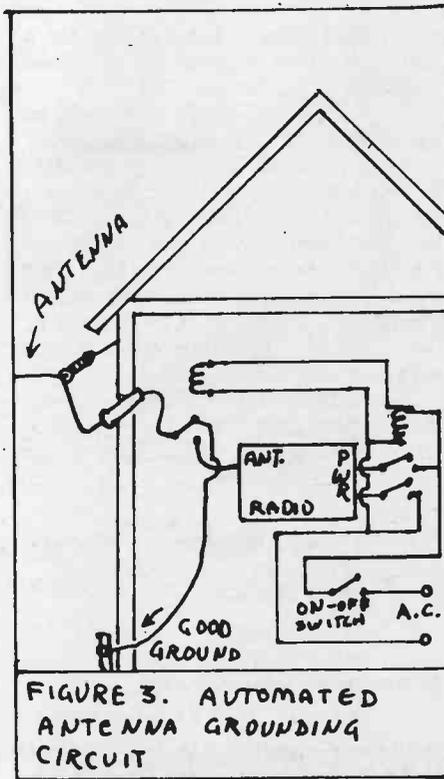
**FIGURE 3. AUTOMATED ANTENNA GROUNDING CIRCUIT**
