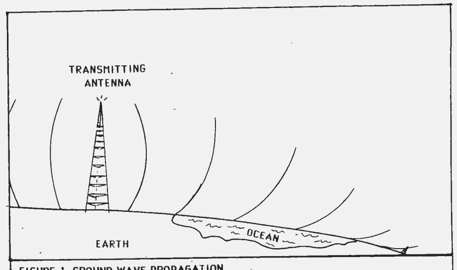
FIGURE 1. GROUND WAVE PROPAGATION.
