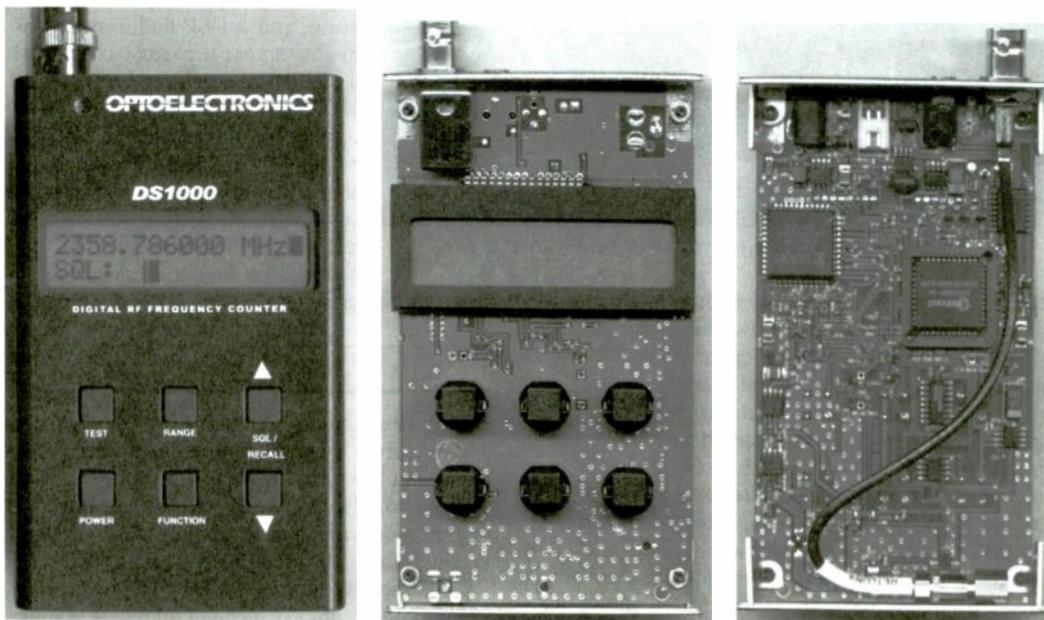
Optoelectronics DS1000, inside front view, DS1000 inside rear view.
