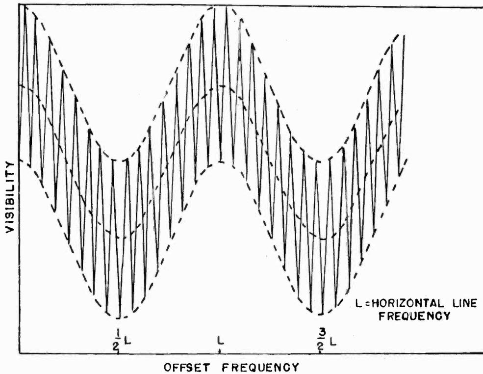
VISIBILITY OF CO-CHANNEL INTERFERENCE AS A FUNCTION OF THE OFFSET FREQUENCY.
