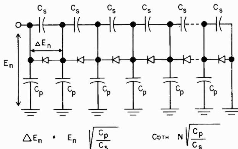
STEP FUNCTION INPUT VOLTAGE
