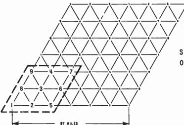
SAMPLE GRID BASED ON REPETITION OF BASIC 9-SITE RHOMBUS
