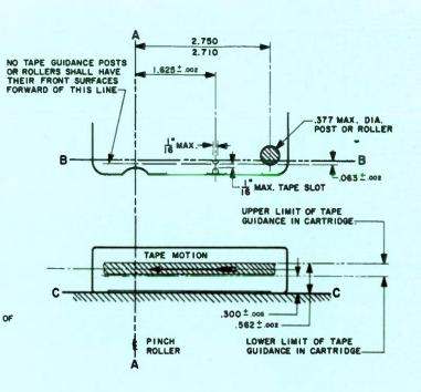
FIG. 4 TAPE GUIDANCE LIMITS
