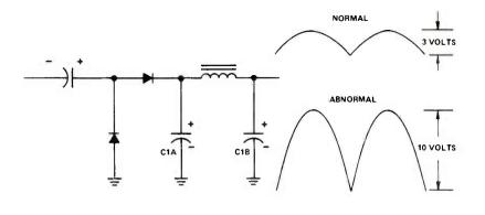
FIGURE 4. POWER SUPPLY OUTPUT WAVEFORMS.
