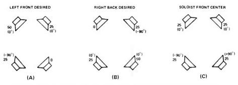
FIGURE 3. POWER AND PHASE DISTRIBUTION FOR THE SANSUL QS DECODER.
