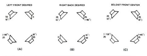
FIGURE 2. POWER AND PHASE DISTRIBUTION FOR THE COLUMBIA SQ SYSTEM.
