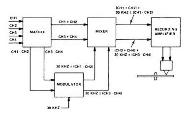
FIGURE 7. FOUR-CHANNEL DISC RECORDING PROCESS.
