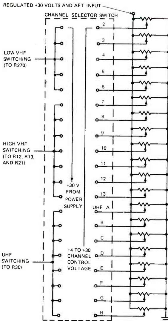
FIGURE 7. ARRANGEMENT FOR CHANNEL SELECTION OF ELECTRONIC TUNERS.
